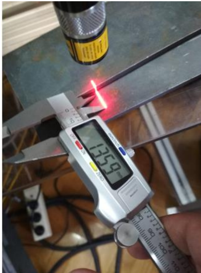
Slika 37: Duljina donje (dulje) laserske zrake
