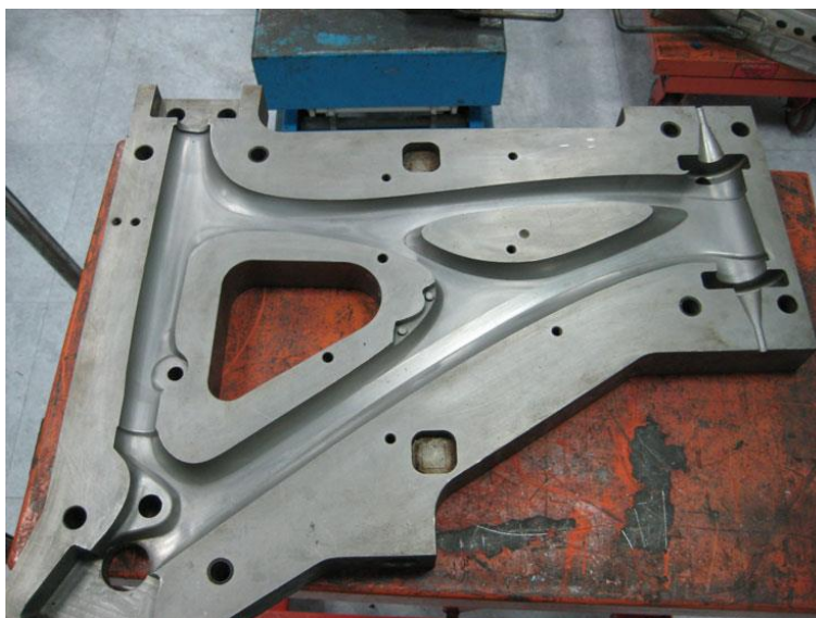
Slika 22. Otvoreni kalup za prednji okvir [13]
