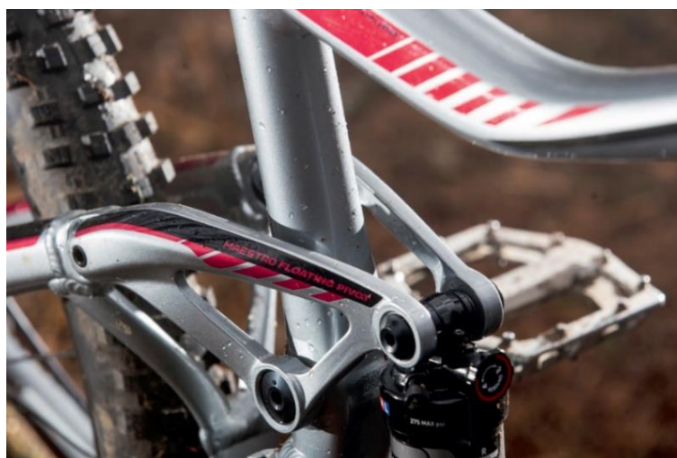
Slika 26. Tvornička izvedba klackalice iz dva dijela [16]
