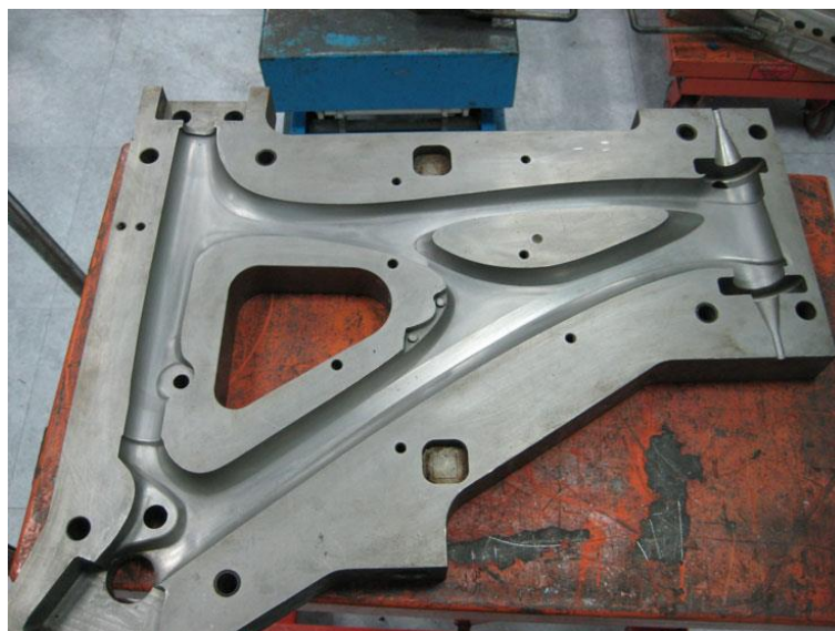
Slika 22. Otvoreni kalup za prednji okvir [13]
