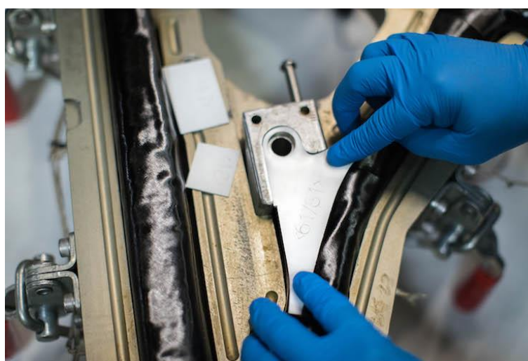
Slika 21. Slaganje slojeva prepreg -a u kalup [13]
