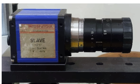
Slika 31. Videoekstenzometar / Markeri na epruveti
