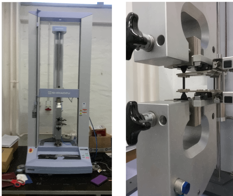
Slika 27. Kidalica Shimadzu AGS-x (USA) / Prikaz epruvete postavljene u čeljusti kidalice
