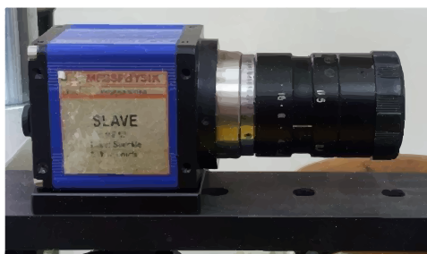
Slika 31. Videoekstenzometar / Markeri na epruveti
