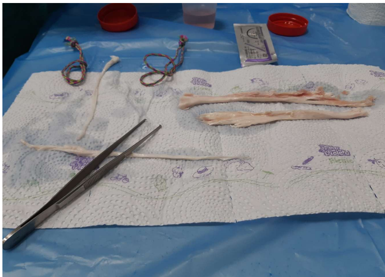
Slika 17. Uzorci ovčjih tetiva prije pripreme za ispitivanje na kidalici
