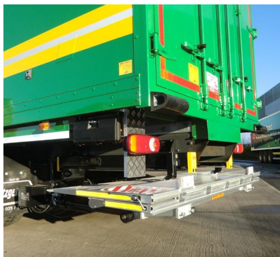
Slika 30. Utovarna platforma, sklopiva [25]
