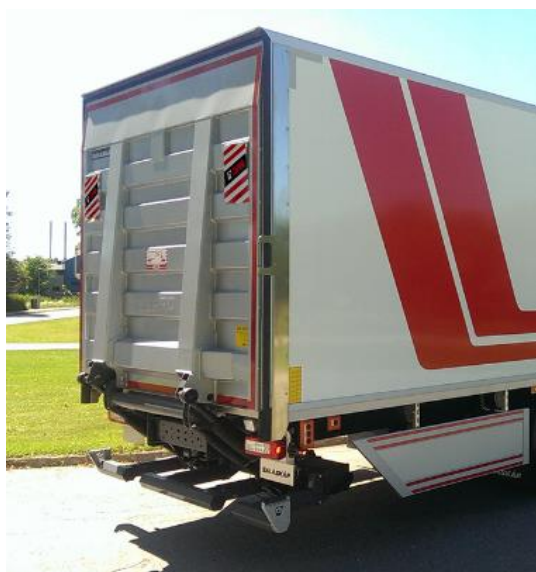
Slika 29. Utovarna platforma, konzolna [25]
