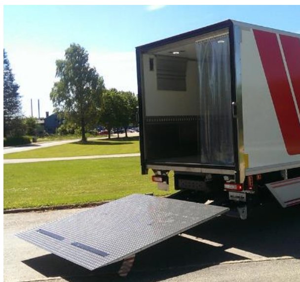
Slika 29. Utovarna platforma, konzolna [25]
