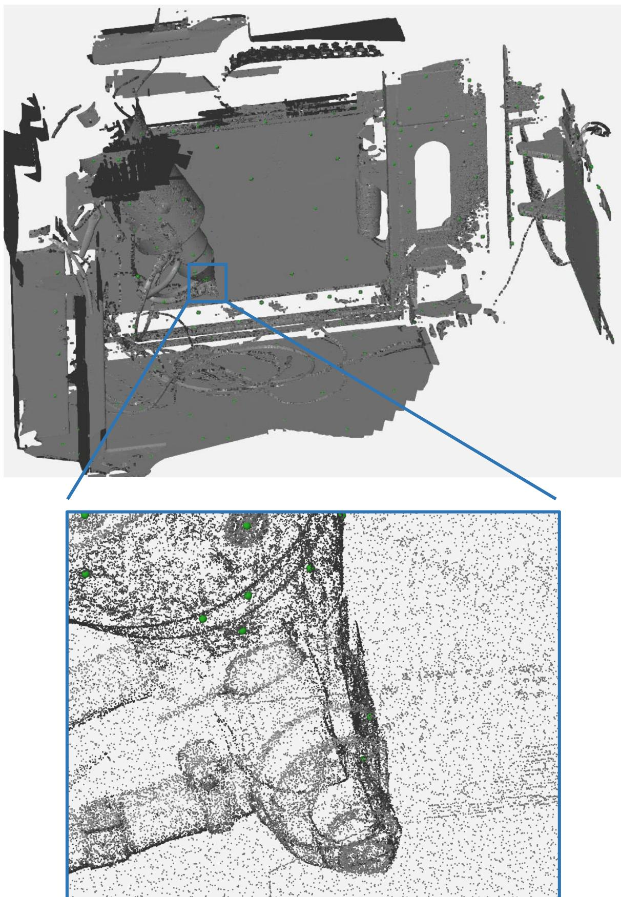
Slika 46 Rezultat skeniranja unutrašnjosti CT uređaja – oblak točaka
