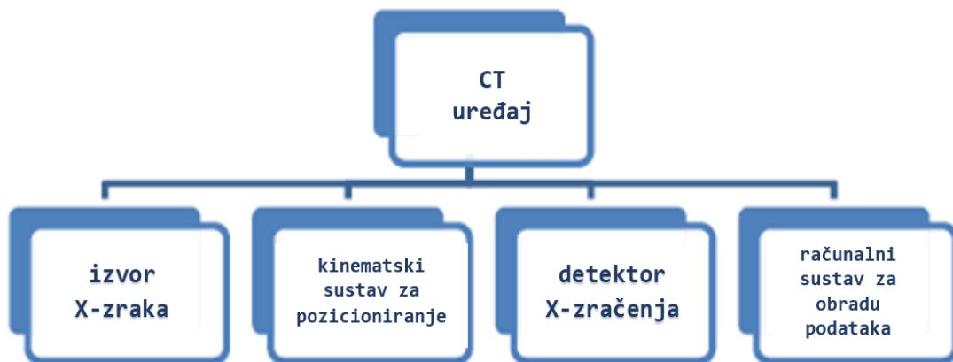
Slika 4 Shematski prikaz strukture CT uređaja [1]
