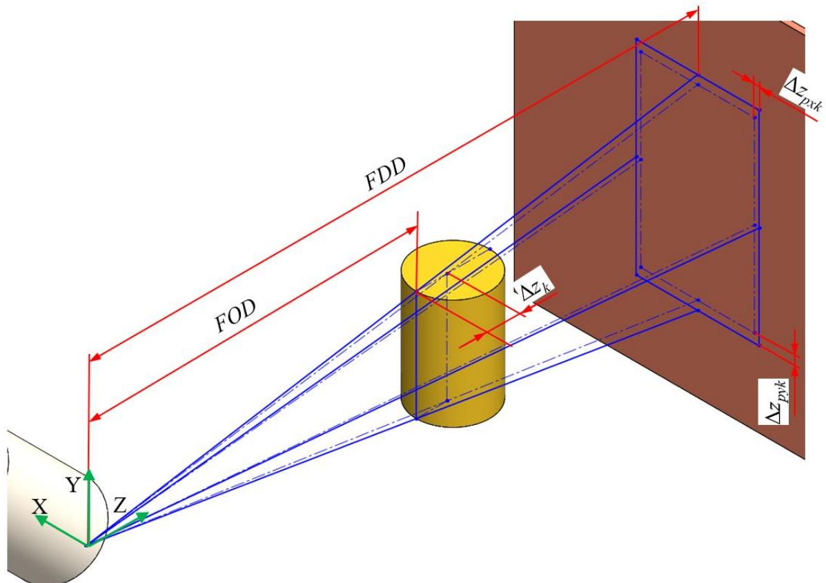
Slika 41 Pomak manipulatora u smjeru osi Z
