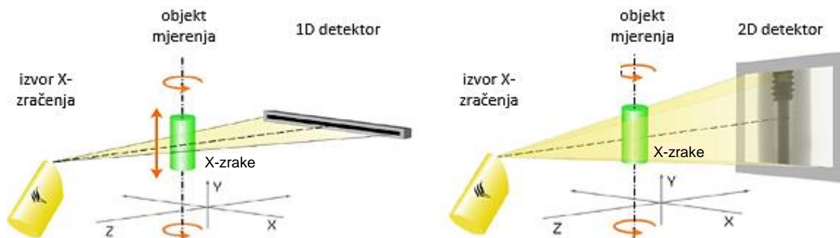
Slika 5 Shematski prikaz linijskog CT uređaja (lijevo) i konusnog CT uređaja (desno) [2]
