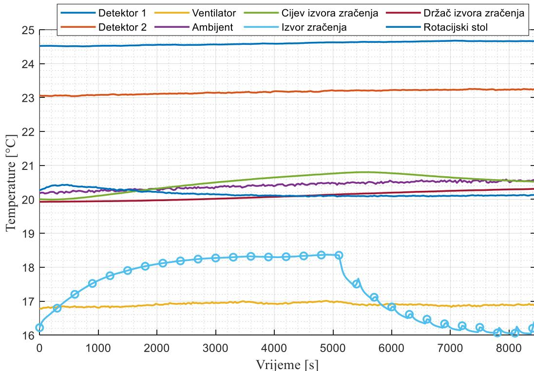
**Slika 73 Izmjerene temperature na CT uređaju pri snazi od 10 W – svjetloplavi krugovi označavaju trenutak snimanja predmeta**
