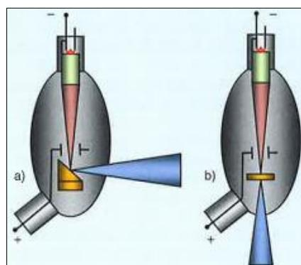
**Slika 12 Reflektirajuća meta (lijevo) i propusna meta (desno) [5]**
