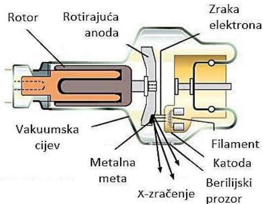
**Slika 11 Shematski prikaz izvora X-zračenja s rotirajućom anodom [6]**
