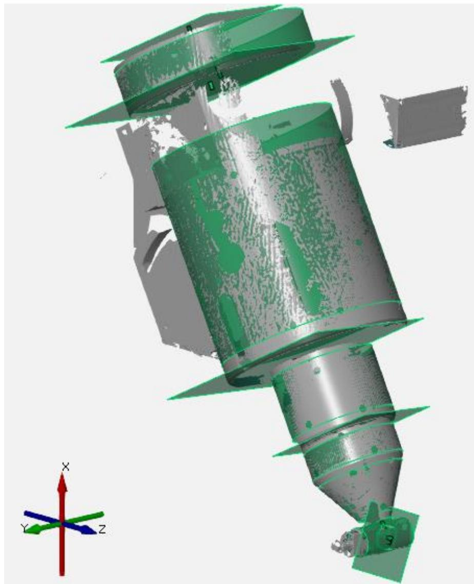
Slika 49 Značajke dobivene kontaktnim mjerjenjem izvora X-zračenja
