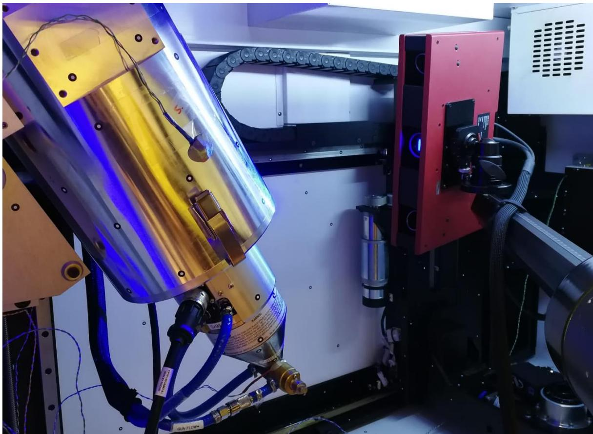
Slika 44 Proces beskontaktnog 3D skeniranja izvora X-zračenja
