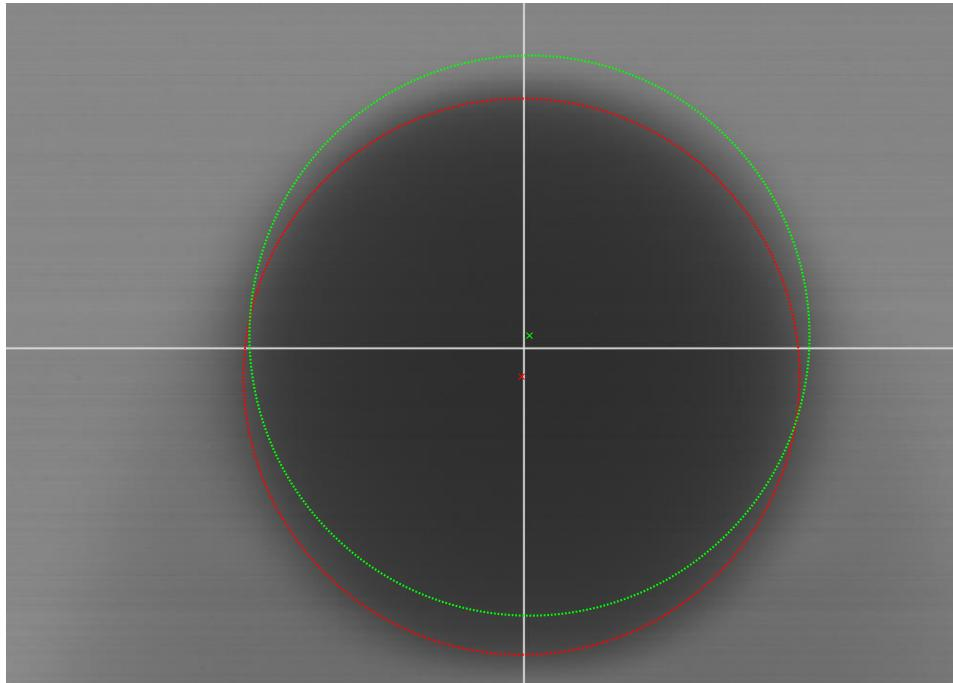
**Slika 71 Usporedba detektirane kružnice na prvoj (crveno) i osamnaestoj projekciji (zeleno)**
