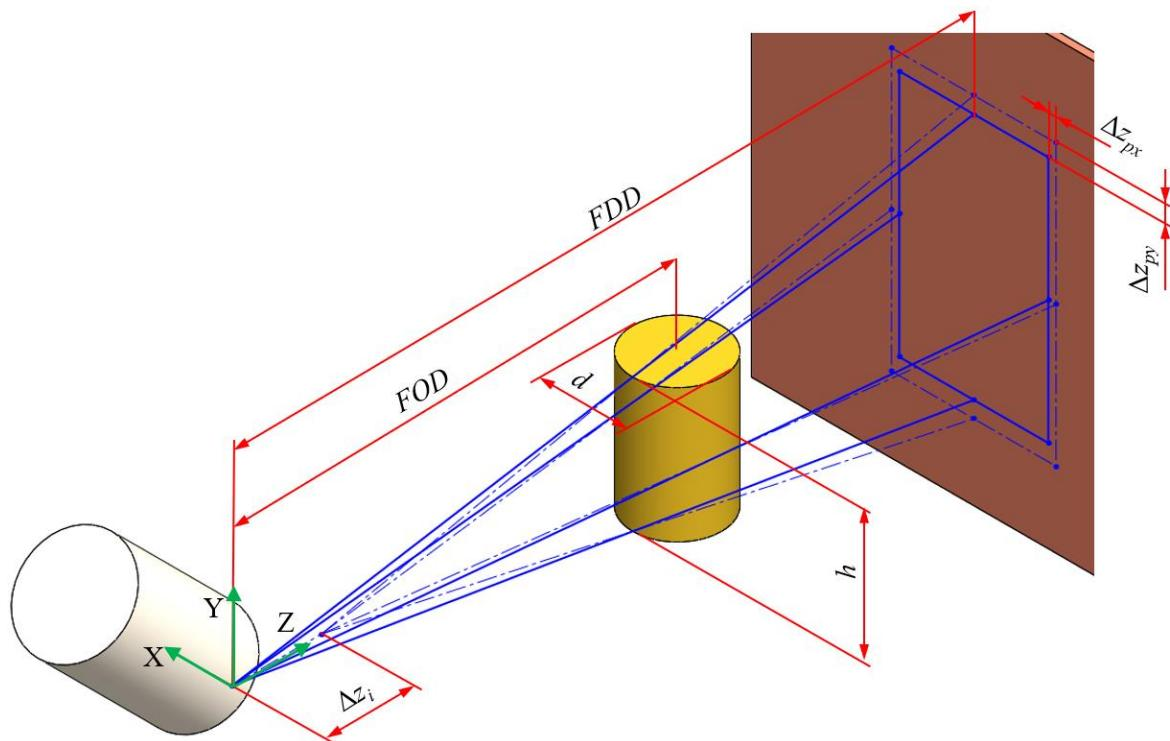
Slika 36 Pomak žarišne točke u smjeru osi Z
