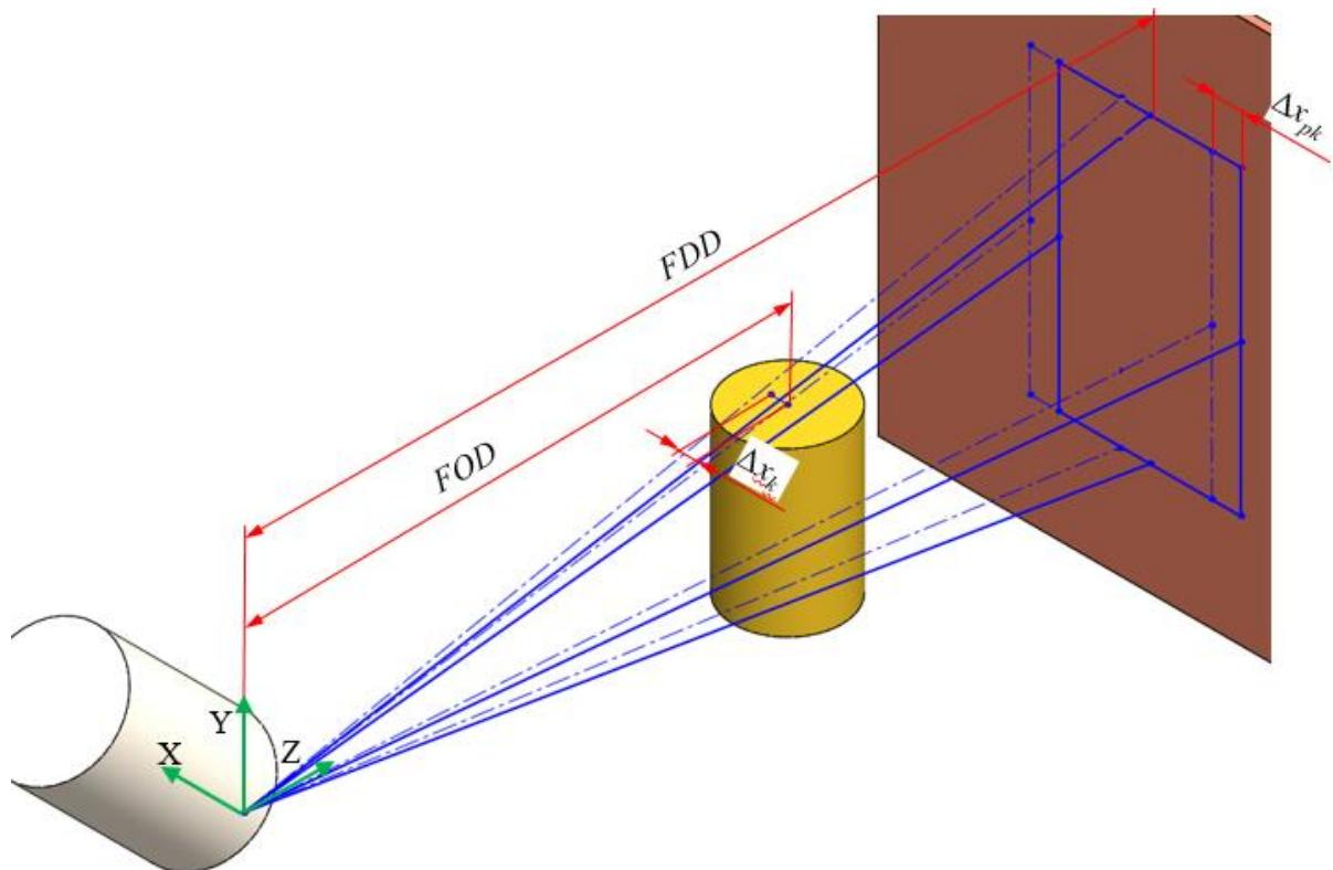
Slika 39 Pomak manipulatora u smjeru osi X
