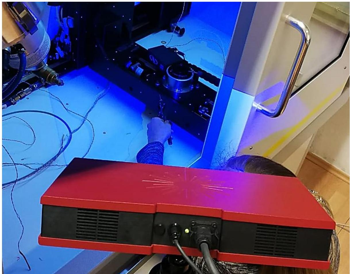
**Slika 45 Proces kontaktnog 3D mjerjenja manipulatora pomoću mjernog ticala**
