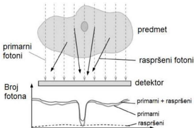
Slika 28 Princip raspršenog zračenja i utjecaj na intenzitet [8]
