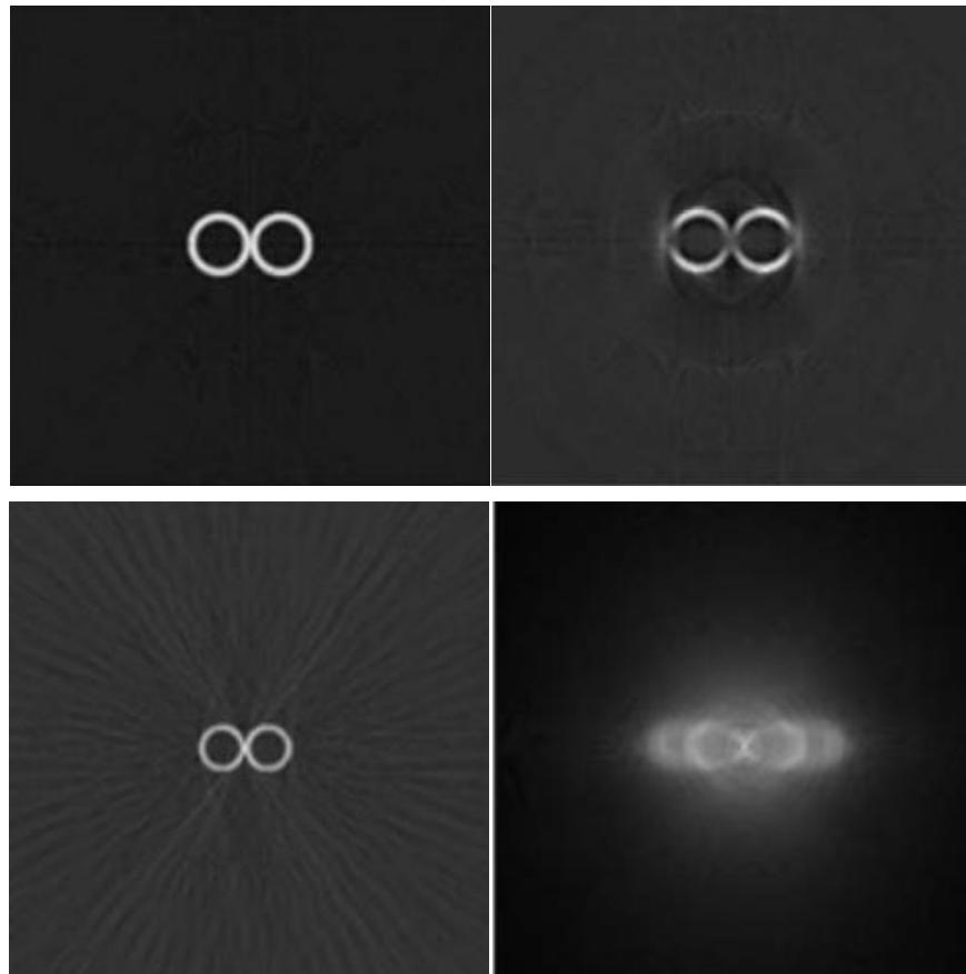
Slika 31 Artefakti uslijed zakretanja detektora [14]
