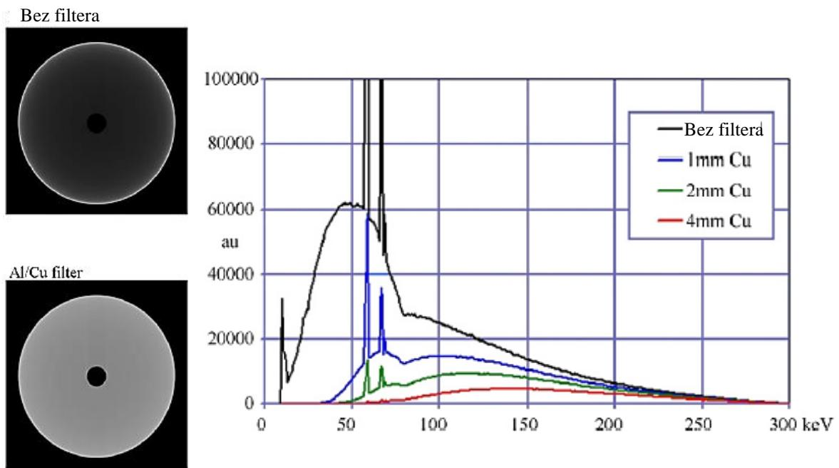
**Slika 27** Snimka s artefaktom otvrđnjavanja zračenja (gore lijevo) i snimka dobivena filtriranim zračenjem bez artefakta (dolje lijevo) te usporedba intenziteta zračenja s različitim debljinama filtera (desno) [3]
