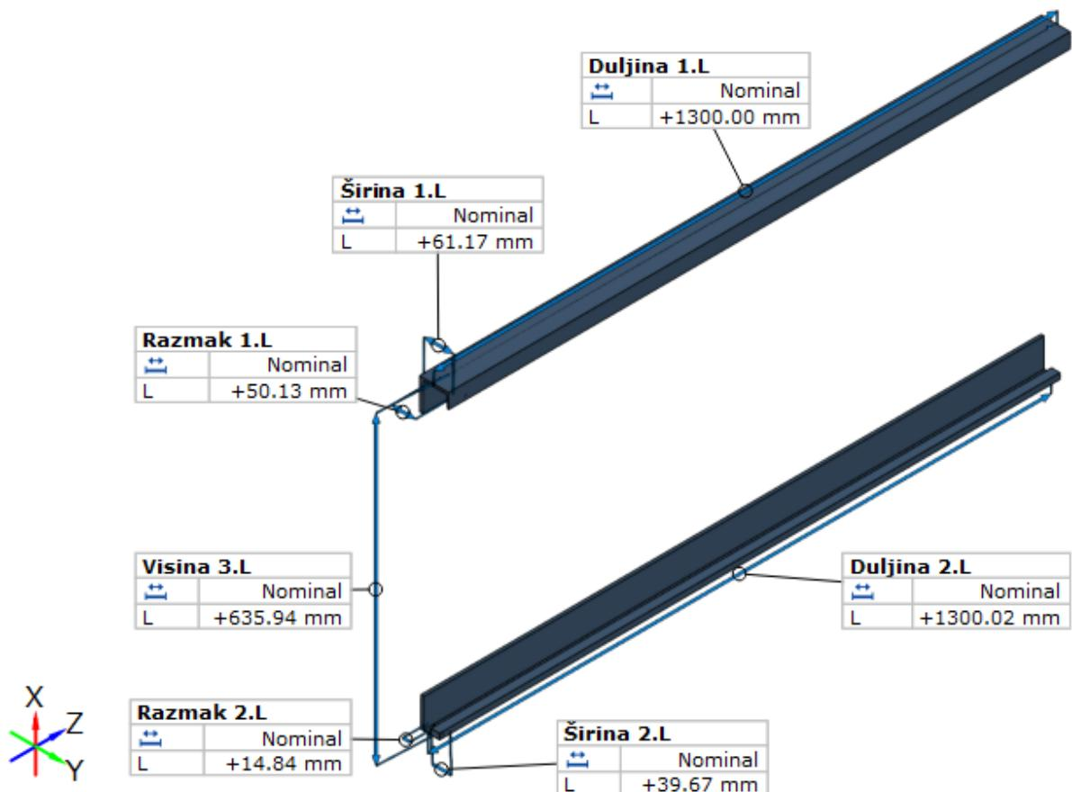
Slika 64 Dimenzije glavnih značajki rekonstruiranog CAD modela vodilica
