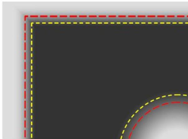
**Slika 26 Utjecaj odabira vrijednosti praga na odstupanje dimenzija vanjskih i unutarnjih značajki objekta mjerena [2]**
