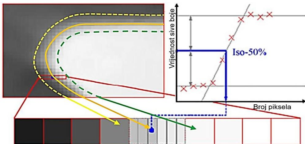
Slika 24 Princip određivanja granične površine primjenom iso-50% praga [3]
