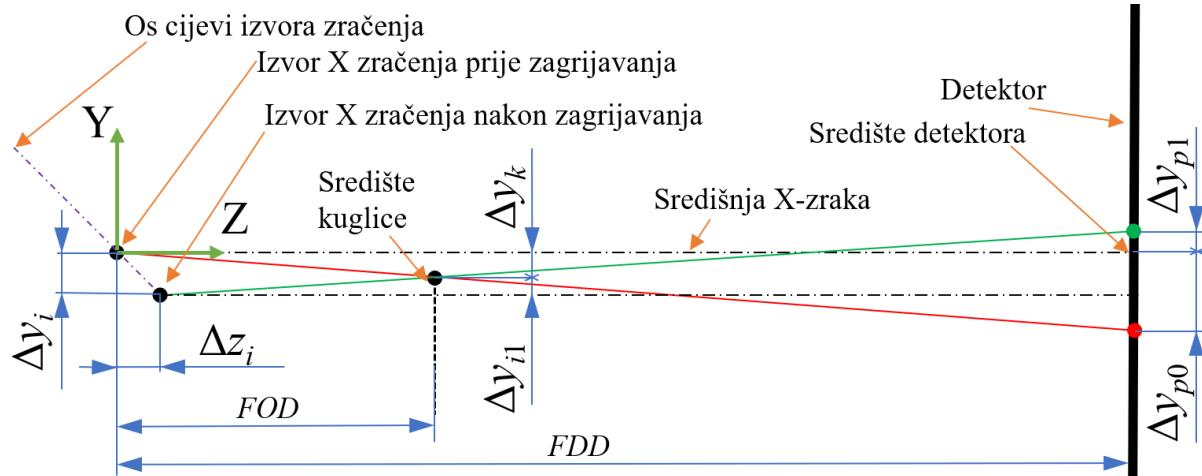
Slika 72 Shematski prikaz pomaka žarišne točke izvora X-zračenja u smjeru osi Y pri snazi od
