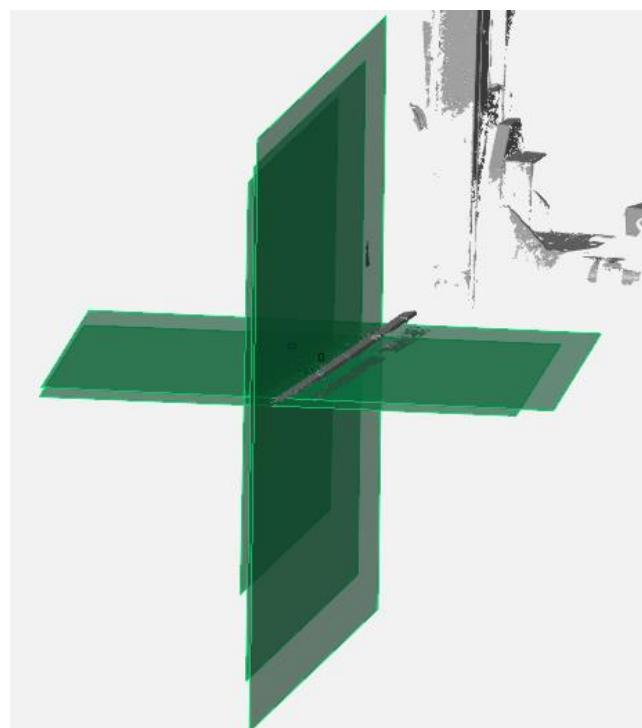
Slika 52 Značajke dobivene kontaktnim mjerjenjem donje vodilice manipulatora
