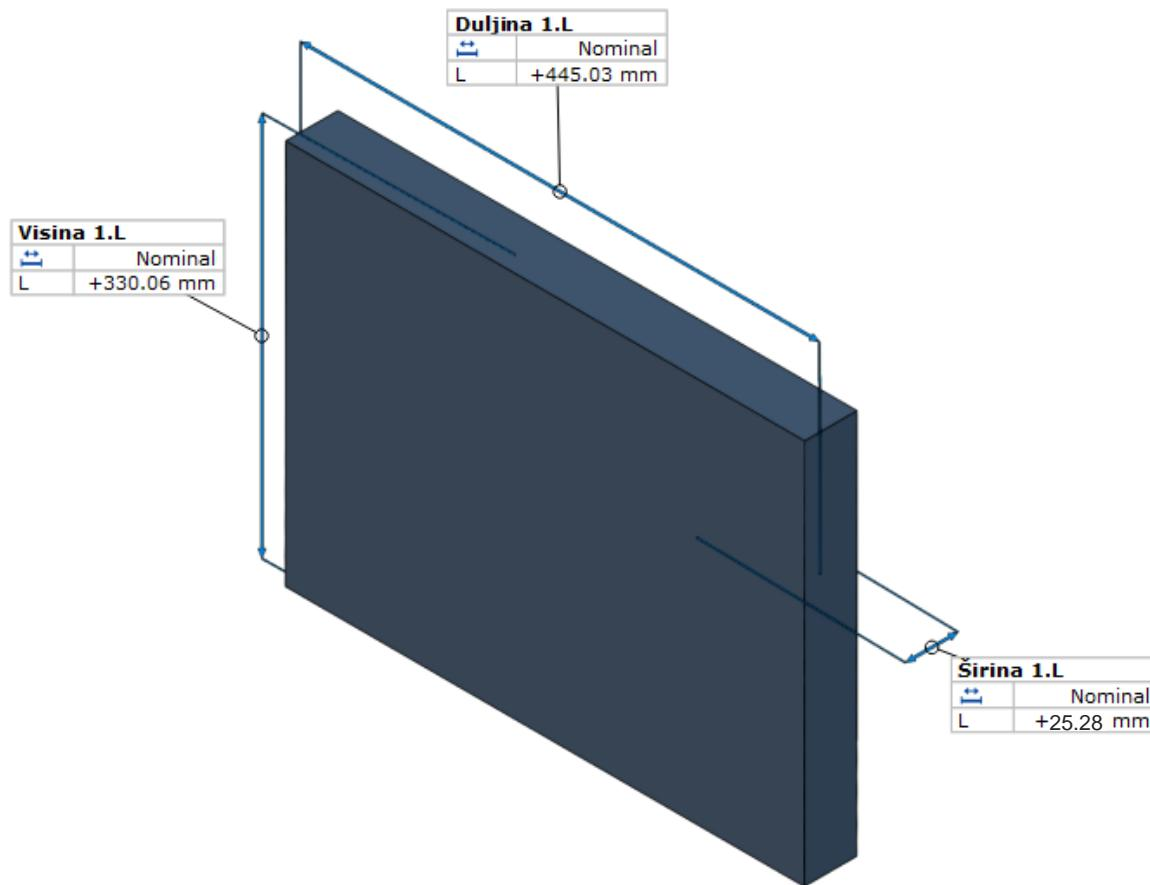
Slika 65 Dimenzijske rekonstruiranog CAD modela detektora X-zračenja
