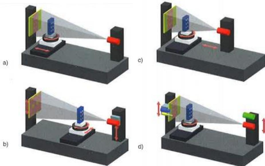
**Slika 18 Primjeri translacijskih osi [1]: a) osnovne osi, b) pomicanje predmeta u ravnini paralelnoj detektoru, c) namještanje kuta konusa, d) izmjena izvora X-zračenja [5]**
