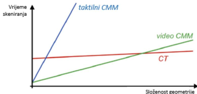
Slika 1 Usporedba brzine skeniranja primjenom različitih tehnologija [4]
