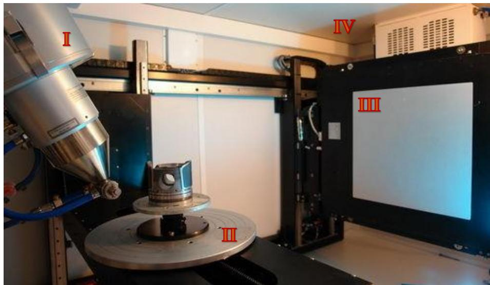
Slika 8 Glavni mehanički dijelovi CT uređaja [7]
