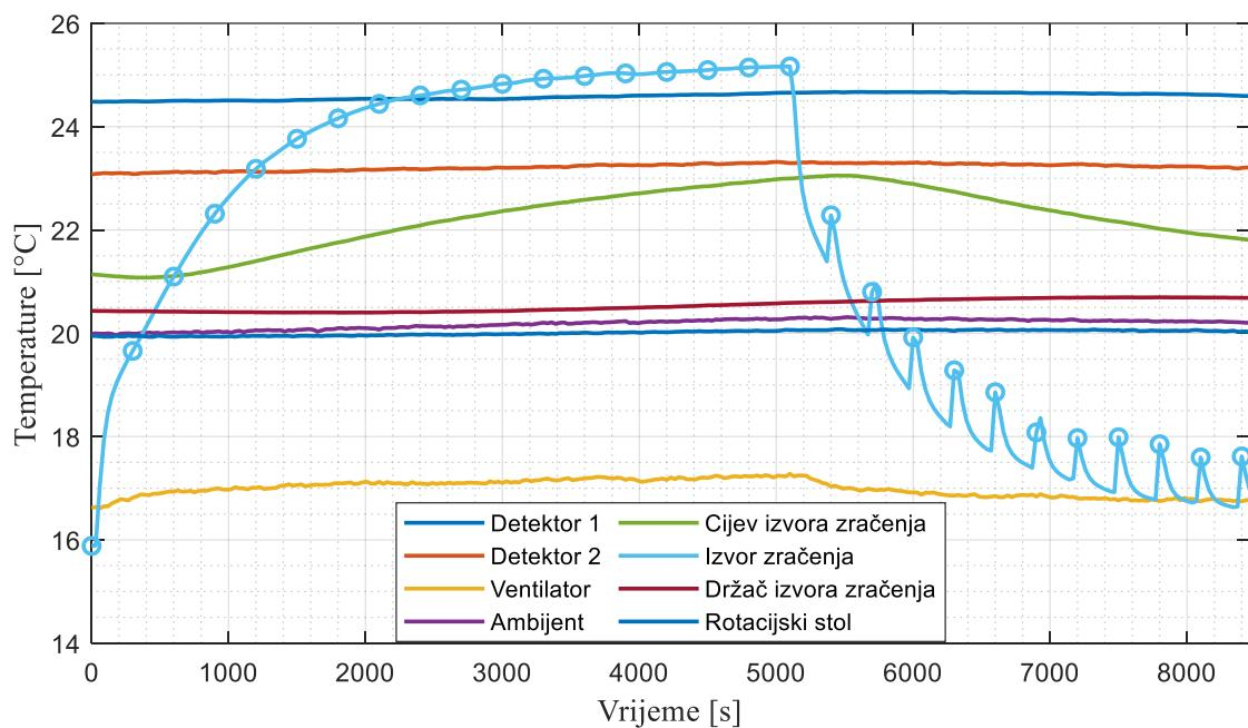
**Slika 68 Izmjerene temperature na CT uređaju pri snazi od 40 W – svjetloplavi krugovi označavaju trenutak snimanja predmeta**
