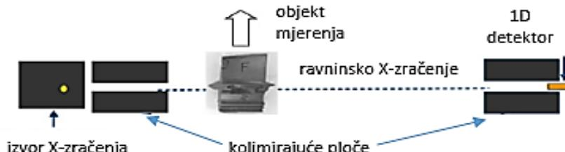
Slika 6 Princip rada linijskog CT uređaja [3]
