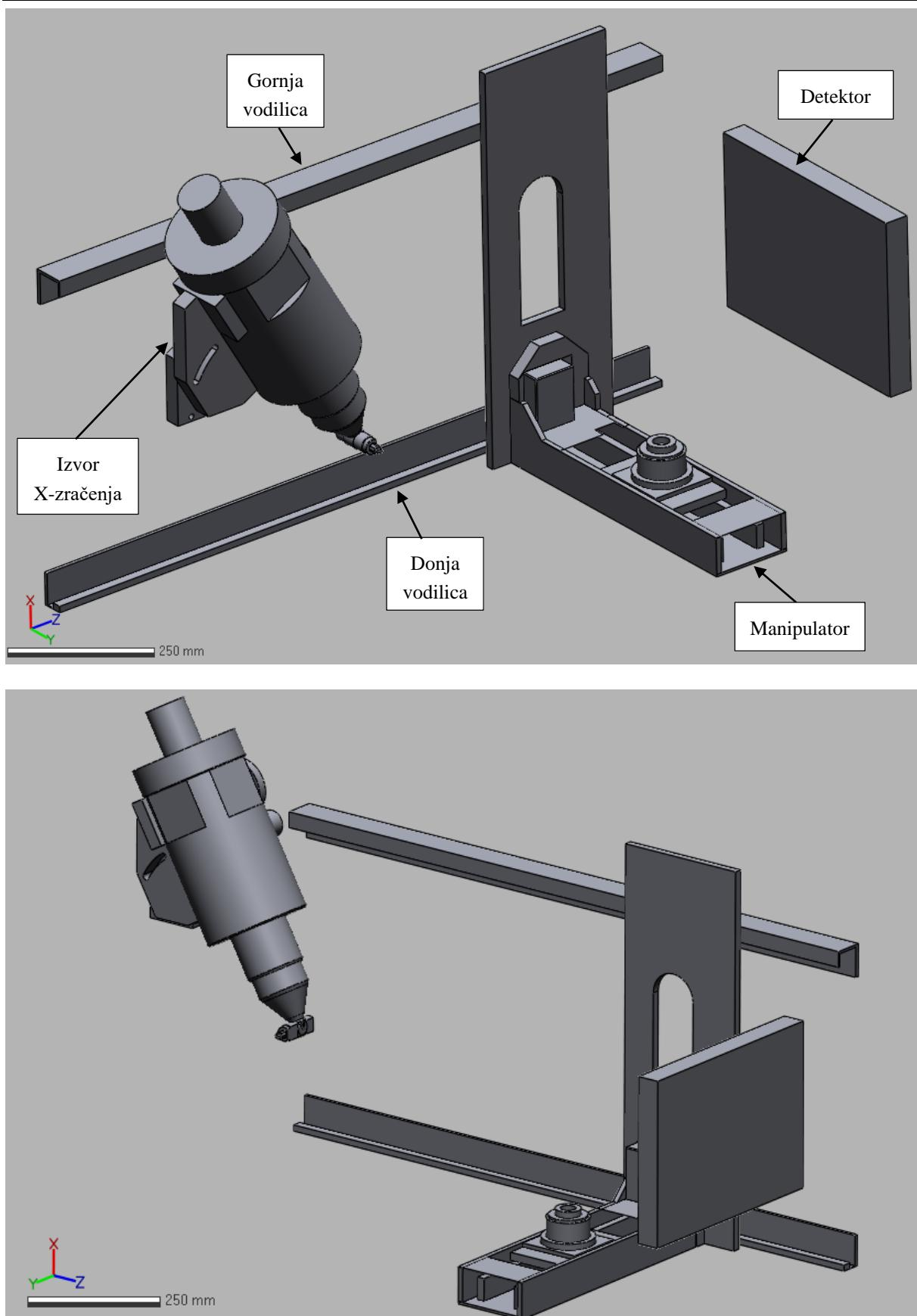
Slika 58 Rekonstruirani CAD model funkcionalnih komponenti CT uređaja
