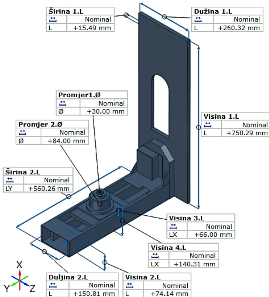
Slika 62 Dimenzije glavnih značajki rekonstruiranog CAD modela manipulatora
