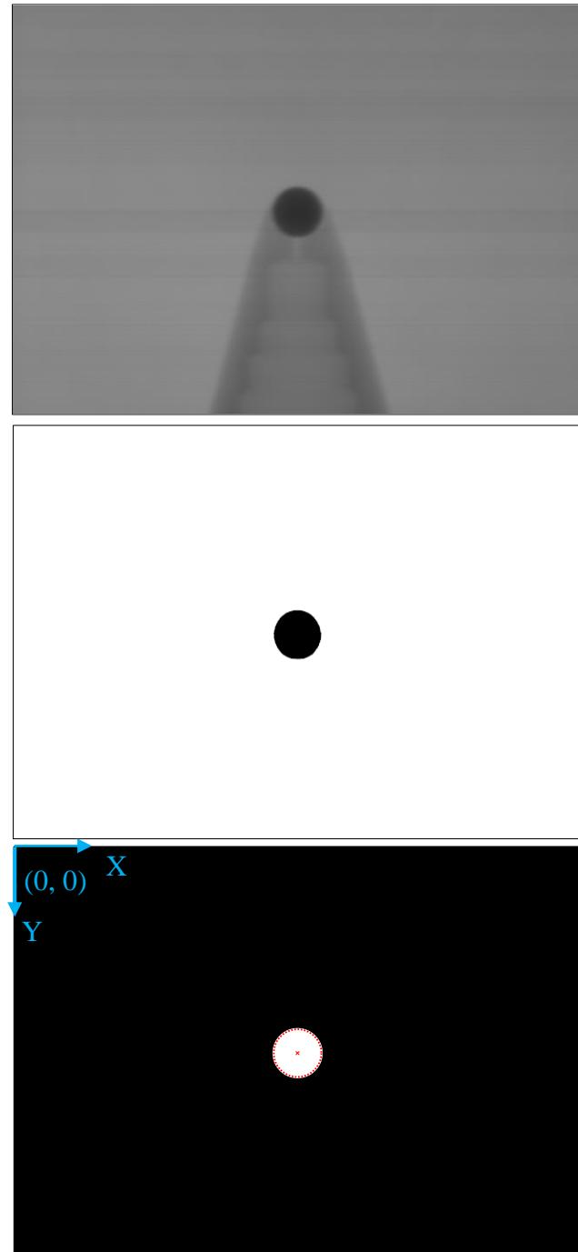
**Slika 69 Koraci obrade slika dobivenih projekcija: slika sivih tonova (gore), binarna slika (sredina) i inverz binarne slike s označenim središtem i kružnicom te ishodištem slike (dolje)**
