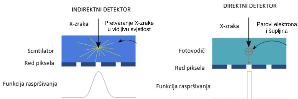
**Slika 16 Razlika između signala indirektnog i direktnog detektora [10]**
