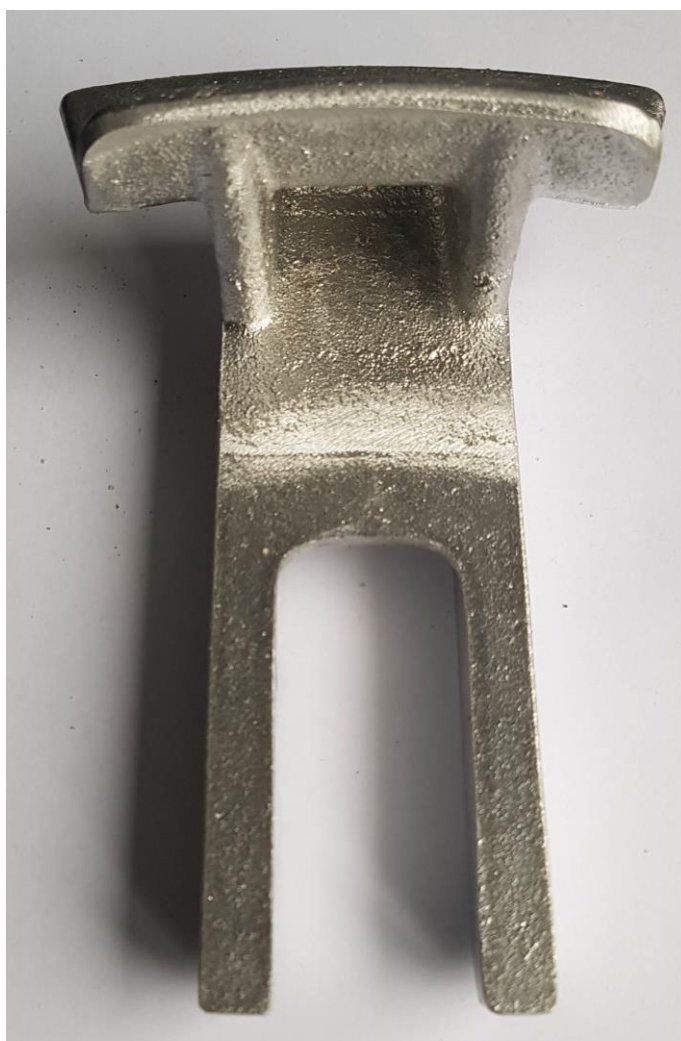
Slika 52. Odljevak nakon uklanjanja uljevnog sustava
