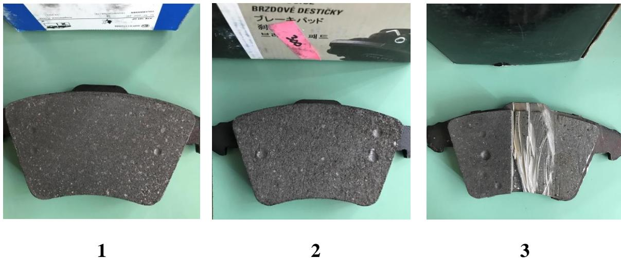
Slika 6.4 Otisci uređaja za ispitivanje tvrdoće na uzorcima
