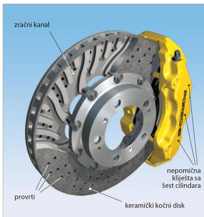
**Slika 2.6 Presjek disk kočnica [1]**
