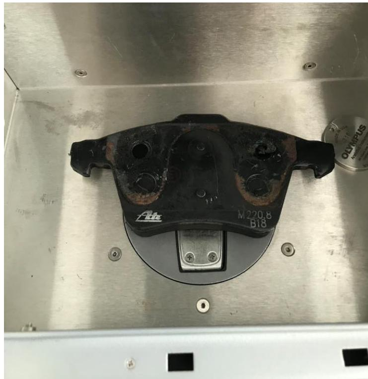
**Slika 6.9 Uzorak tijekom ispitivanja na XRF uređaju**
