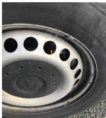
Slika 6.26 Plamen na kočionoj oblozi nakon 9. ispitivanja
