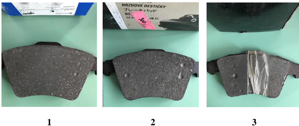
Slika 6.4 Otisci uređaja za ispitivanje tvrdoće na uzorcima
