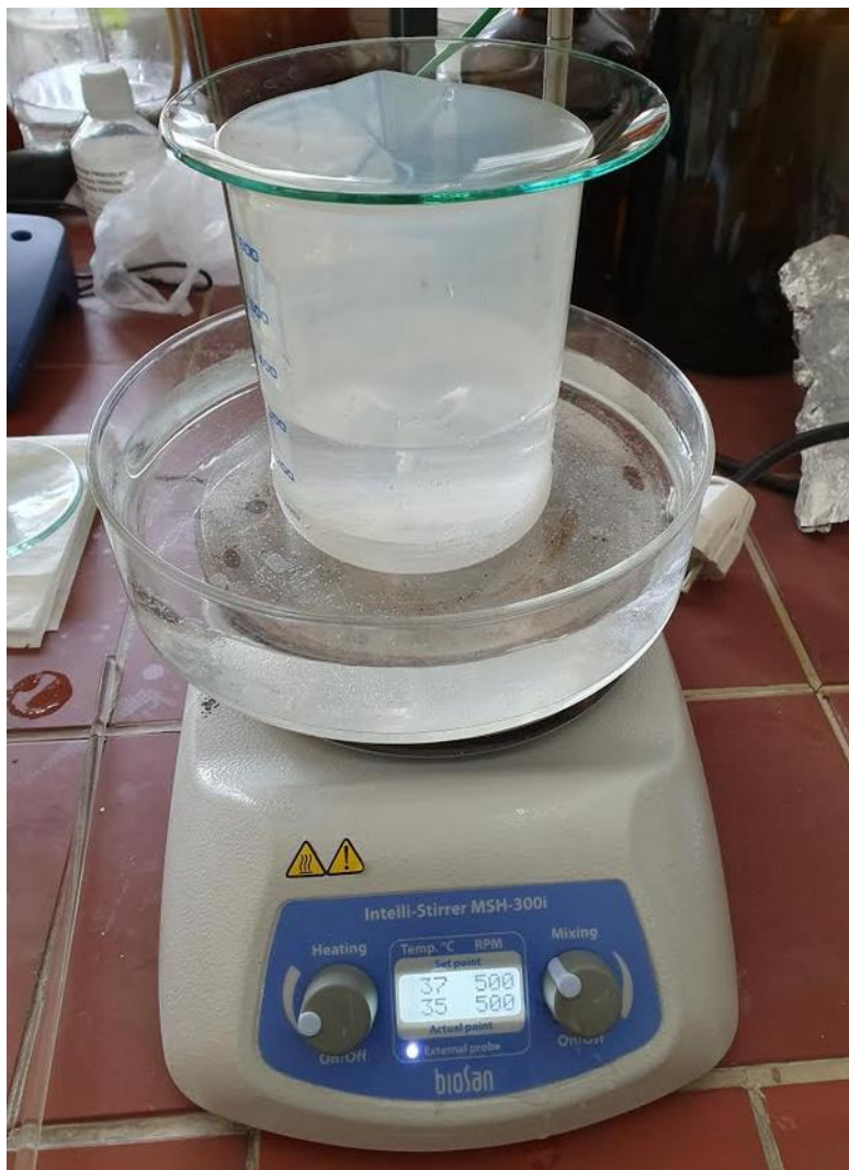
Slika 16 Fotografija magnetske miješalice tijekom zagrijavanja SBF otopine.
