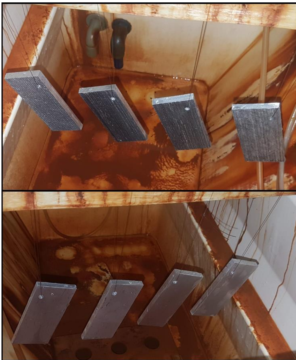
Slika 44. Uzorci postavljeni u slanu komoru
