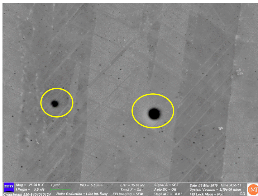
Slika 35. Uzdužni presjek Uzorka 1 prije nanošenja keramičke prevlake, povećanje 25 000x, SEM
