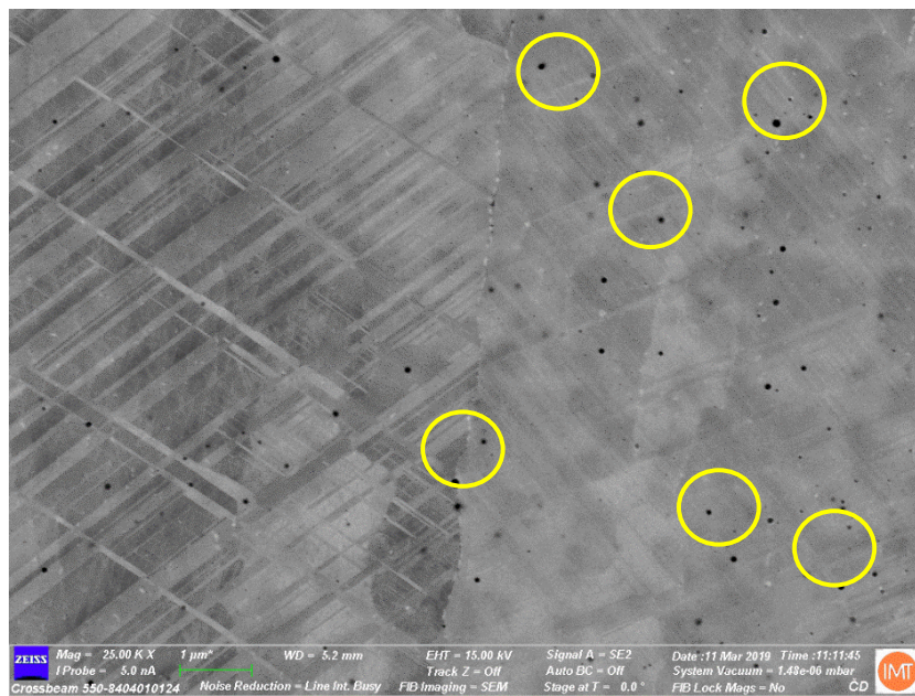
Slika 36. Uzdužni presjek Uzorka 2 prije nanošenja keramičke prevlake, povećanje 25 000x, SEM
