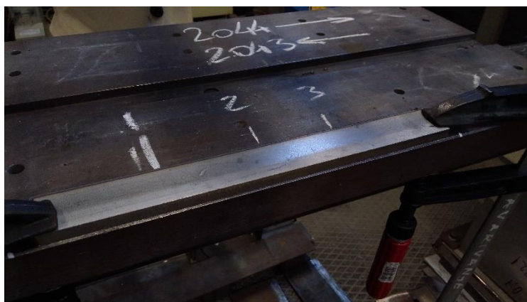
Slika 41. Označena mjesta mjerenja visine zida
