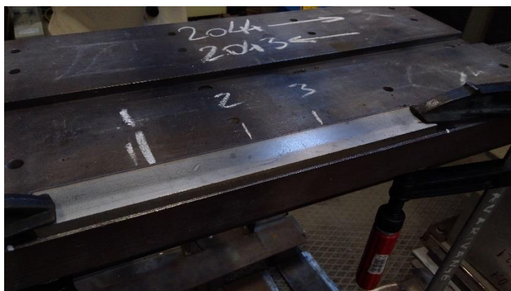
Slika 53. Oznake mjesta mjerenja visine zida
