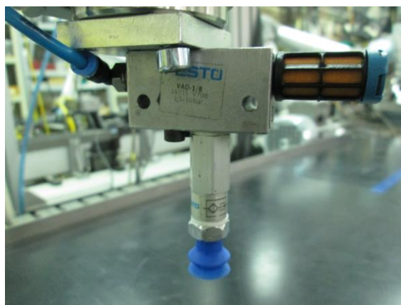
Slika 10. Vakuum sisaljka na FESTO vakuum generatoru.
