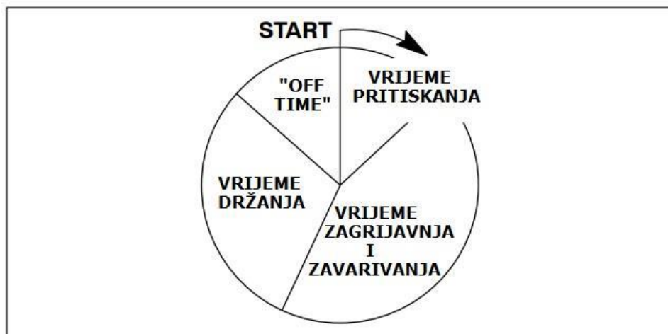
Slika 15. Vremenski ciklusi pri elektrotopnom zavarivanju[16]
