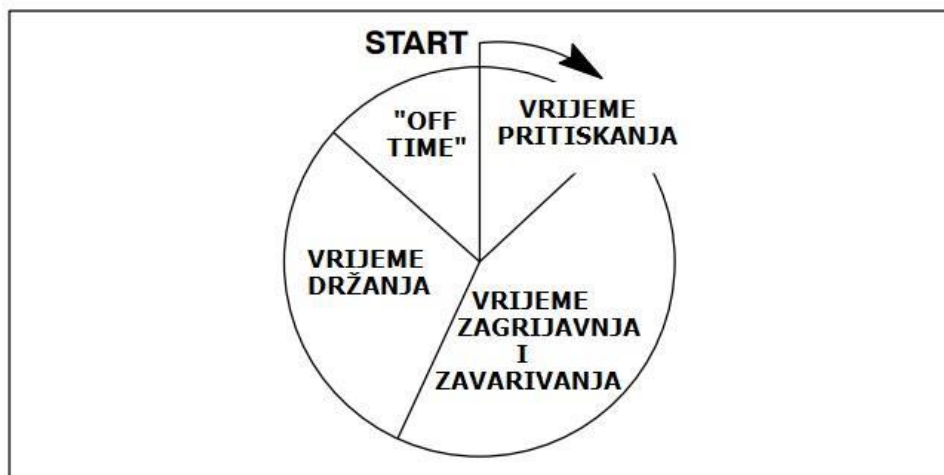
Slika 15. Vremenski ciklusi pri elektrotopnom zavarivanju[16]
