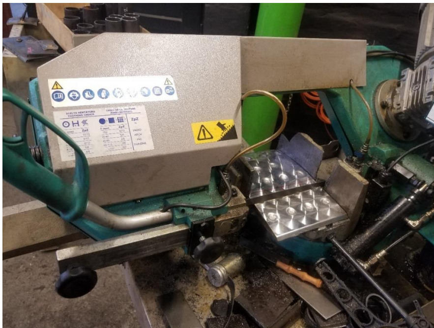
Slika 25. Rezanje uzoraka na tračnoj pili
