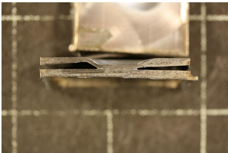
Slika 29. Zavar bez puknuća prije oblaganja polimernom masom
