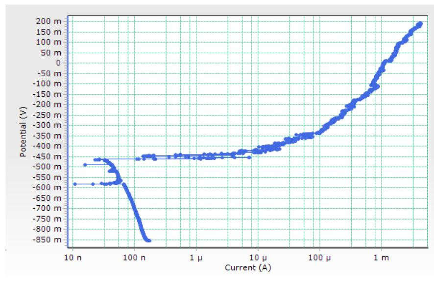
Slika 26. Dijagram anodno-katodne polarizacije uzorka koji je 24 sata bio izložen u otopini 0,01 M NaCl + 0,003 M CeCl<sub>3</sub>
