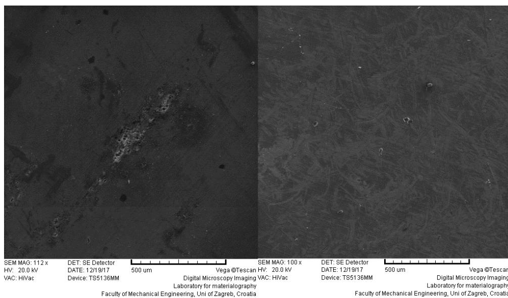
*Slika 33. Prikaz stanja površine uzorka koji je 72 sata bio izložen otopini  $\text{NaCl}$  (lijevo) i uzorka koji je bio izložen 72 sata  $\text{NaCl} + \text{CeCl}_3$  (desno).*
