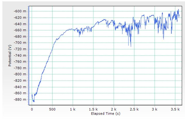
Slika 24. Dijagram otvorenog strujnog kruga za uzorak koji je 24 sata bio izložen  $0,01 \text{ M NaCl} + 0,003 \text{ M CeCl}_3$
