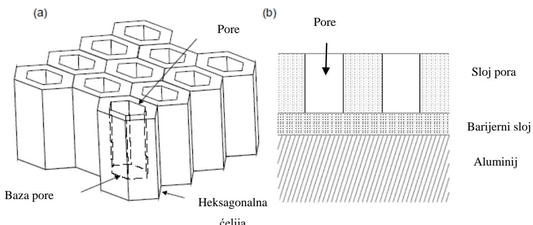
Slika 7. Anodni sloj: a- heksagonalne čelije anodnog sloja, b- presjek [22]
