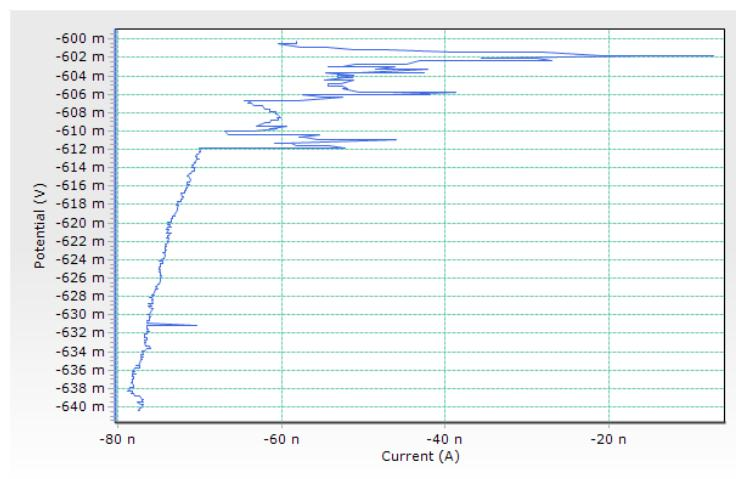
Slika 25. Dijagram linearne interpolacije za uzorak koji je 24 sata bio izložen  $0,01 \text{ M NaCl} + 0,003 \text{ M CeCl}_3$
