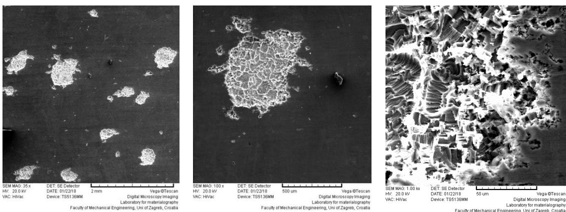
Slika 32. Prikaz oštećene površine na referentnom uzorku uz različita povećanja
