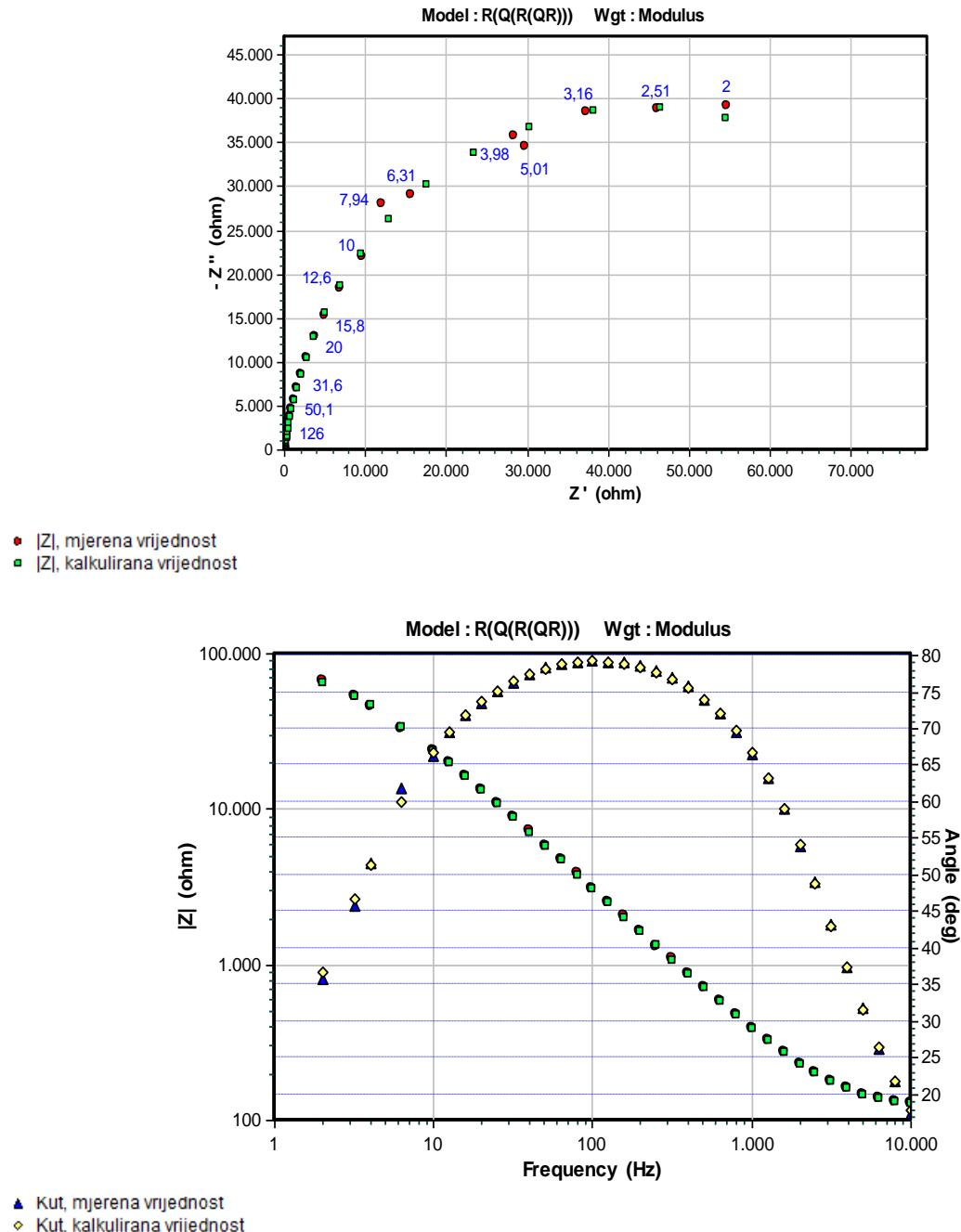
Slika 28. Nyquistov (gore) i Bodeov (dolje) dijagram referentnog uzorka netretirane legure označke 2024 T3.
