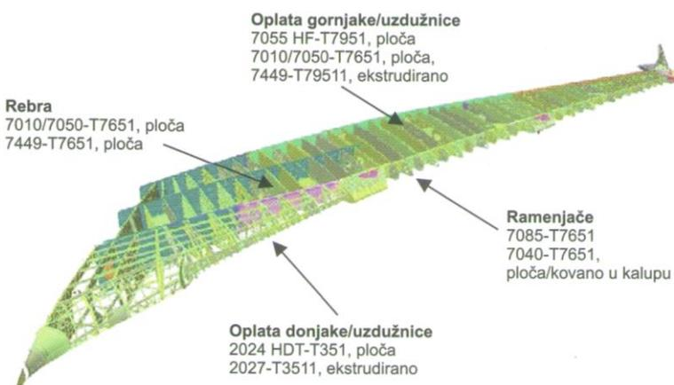
Slika 2. Aluminijeve legure na krilu zrakoplova [7]
