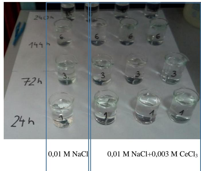
Slika 22. Priprema uzoraka – izlaganje otopini NaCl i otopini NaCl + CeCl<sub>3</sub>
