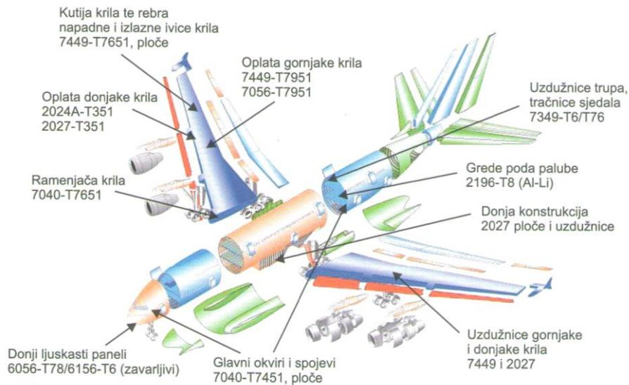
Slika 1. Aluminijeve legure na Airbusu A 380 [7]
