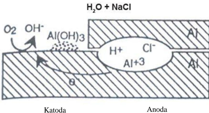
Slika 4. Proces nastanka korozije u procjepu [14]
