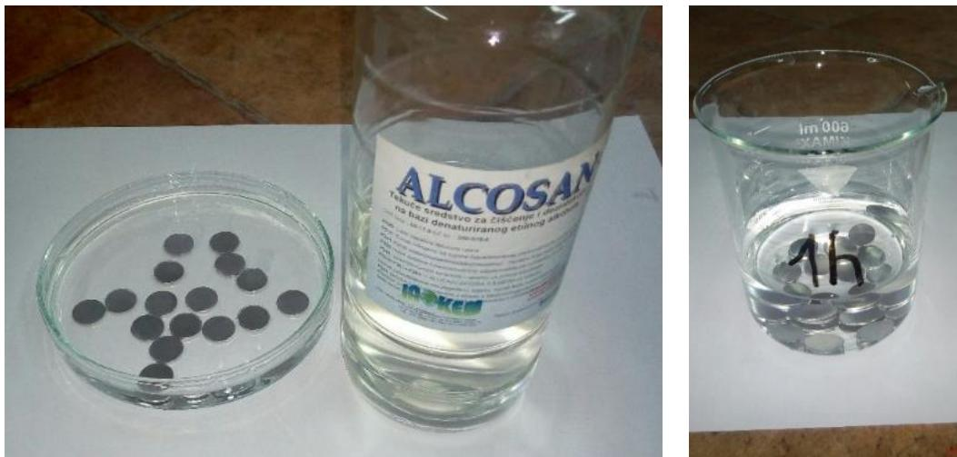
Slika 21. Priprema ispitnih uzoraka - odmašćivanje površine (lijevo) i ispiranje (desno)
