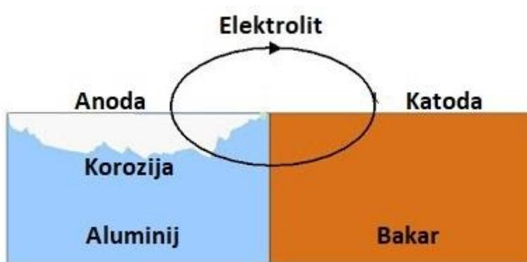
Slika 5. Nastajanje galvanske korozije u leguri Al-Cu [14]
