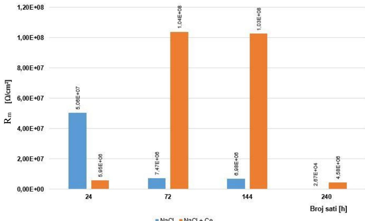
Slika 29. Usporedba otpora uzoraka koji su bili izloženi otopini NaCl-a i uzoraka koji su bili izloženi otopini NaCl+CeCl<sub>3</sub>
