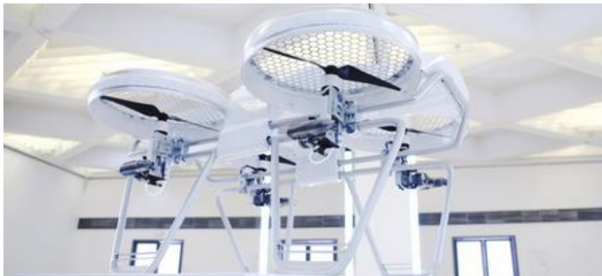
Slika 2.17 Letjelica Yearir s četiri rotora i hibridnim pogonom (prototip) [39]
