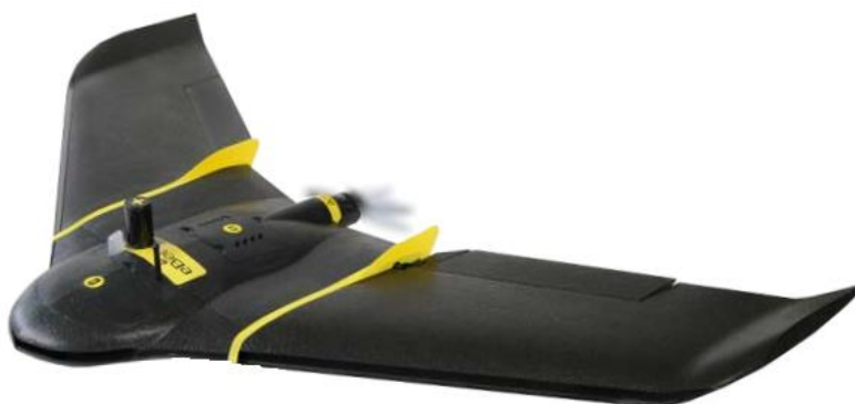
Slika 2.10 BWB dizajn letjelice eBee tvrtke SenseFly [36]
