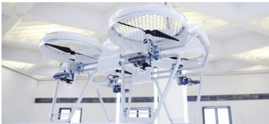
Slika 2.17 Letjelica Yeari s četiri rotora i hibridnim pogonom (prototip) [39]
