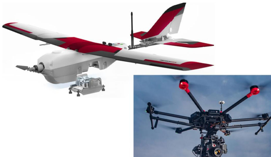
Slika 2.7 HTOL letjelica (s fiksnim krilima) Lancaster 5 tvrtke Precision Hawk (gore) i VTOL letjelica (s rotorima) Matrice 600 tvrtke DJI [18], [19]
