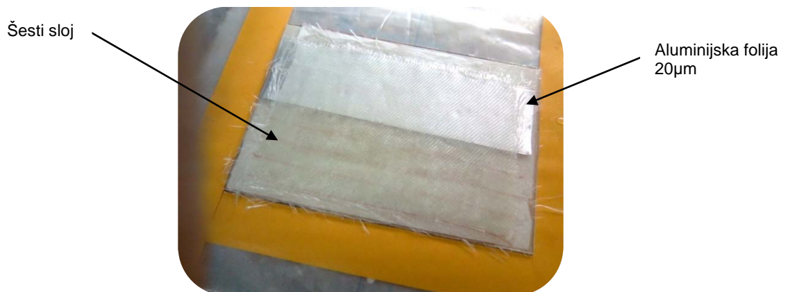
Slika 34 Odvajanje slojeva aluminijskom folijom
