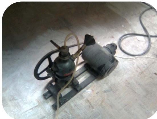
Slika 38 Vakuumpumpa – 150 mbar (85% vakuum)
