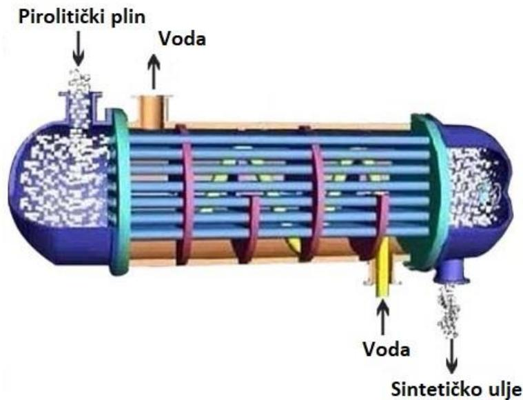
Slika 4.4 Shema kondenzatora<sup>[24]</sup>
