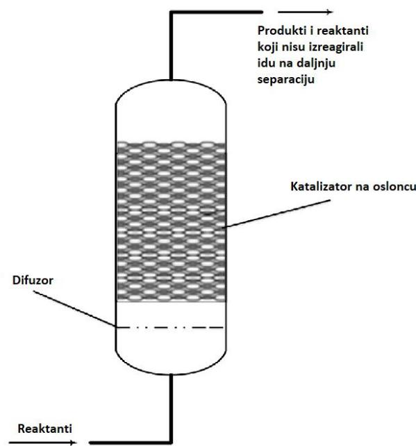
Slika 2.4 Shema reaktora za pirolizu u fiksnom sloju<sup>[10]</sup>
