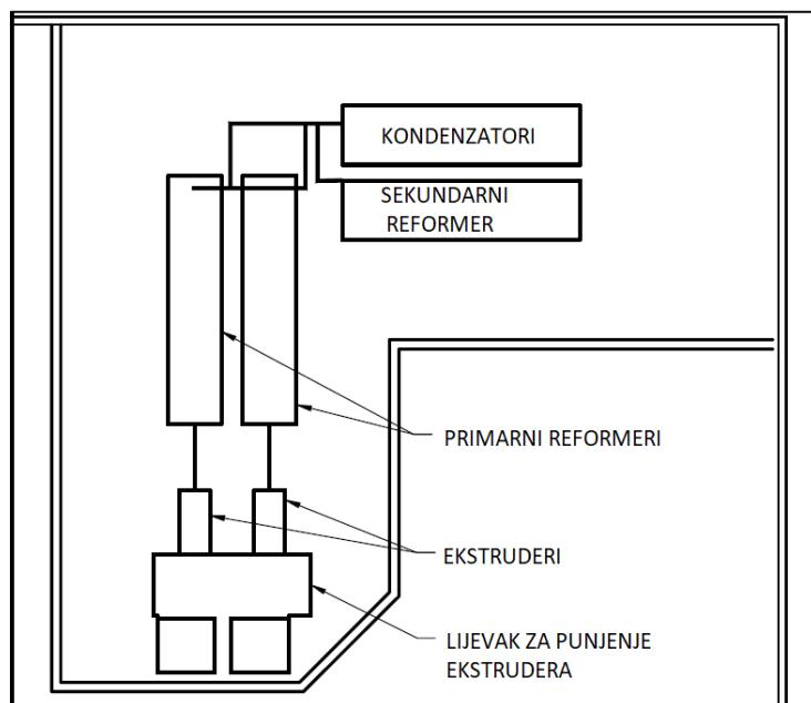
Slika 4.5 Tlocrt postrojenja za piroлизу<sup>[19]</sup>
