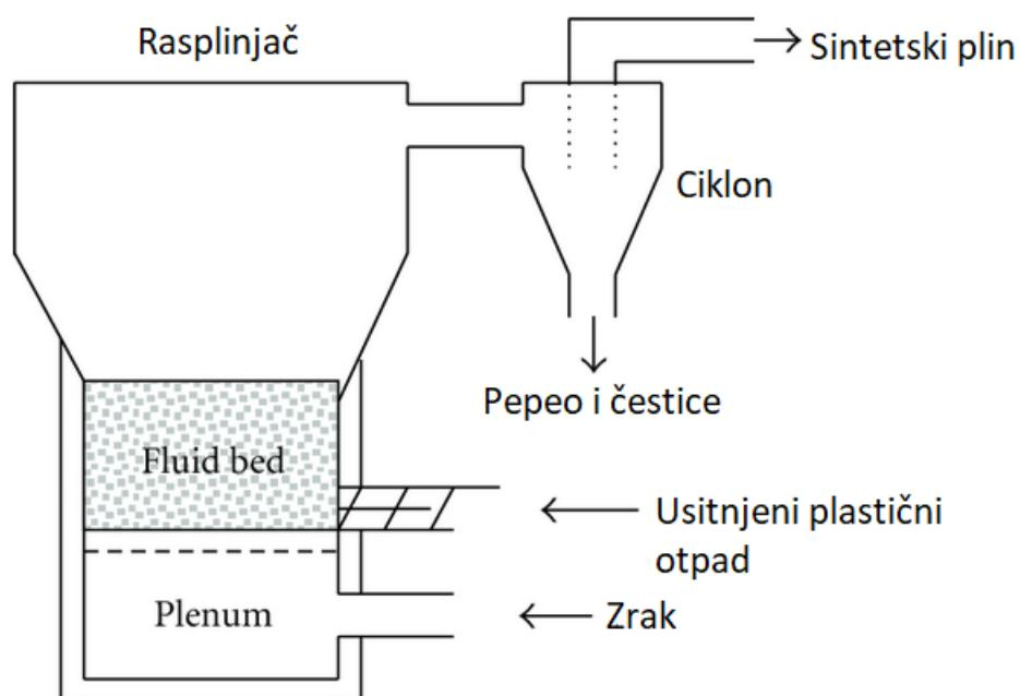
Slika 4.7 Primjer sheme reaktora s ciklonom
