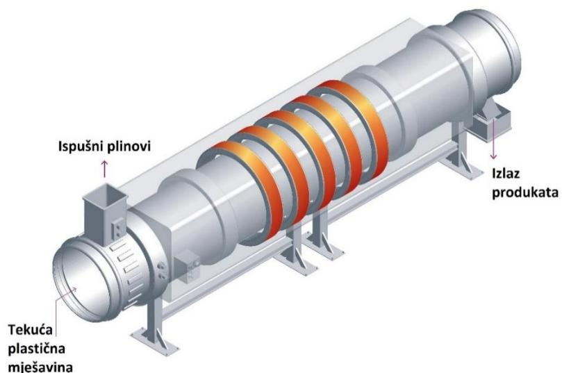
Slika 4.3 Primjer reaktora s rotacijskim bubenjem<sup>[22]</sup>
