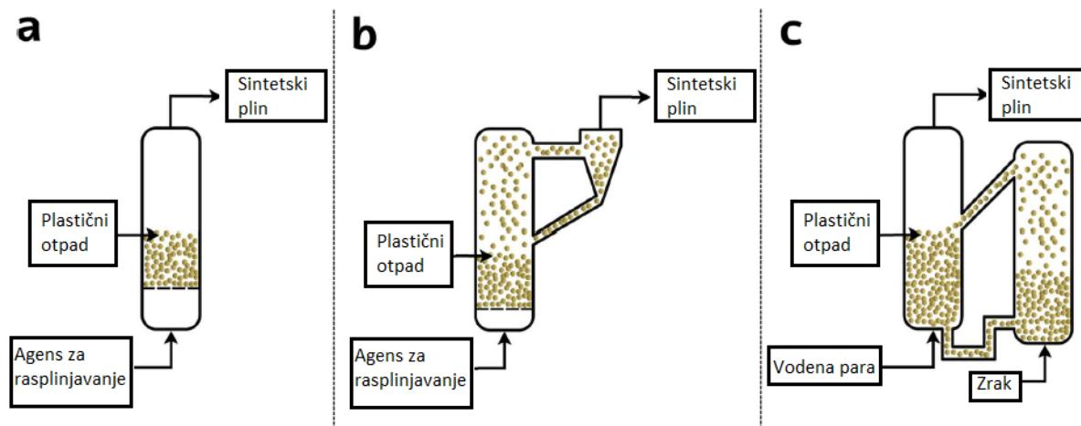
Slika 2.8 Vrste reaktora za rasplinjavanje u fluidizirajućem sloju: a) mjeđučasti, b) cirkulirajući, c) dvojni<sup>[13]</sup>
