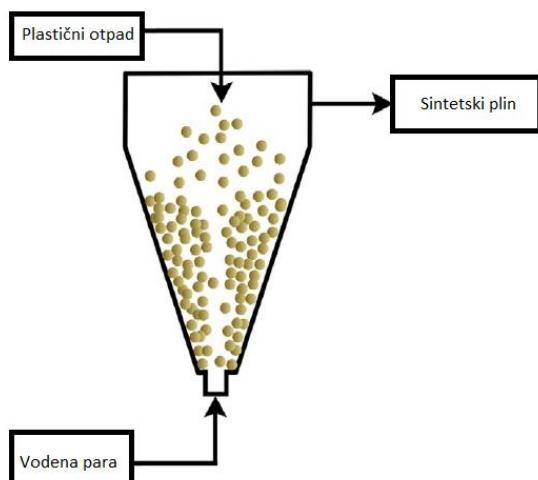
Slika 2.9 Shema konusnog reaktora<sup>[13]</sup>
