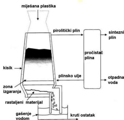
Slika 2.7 Shema PUROX postupka rasplinjavanja<sup>[7]</sup>
