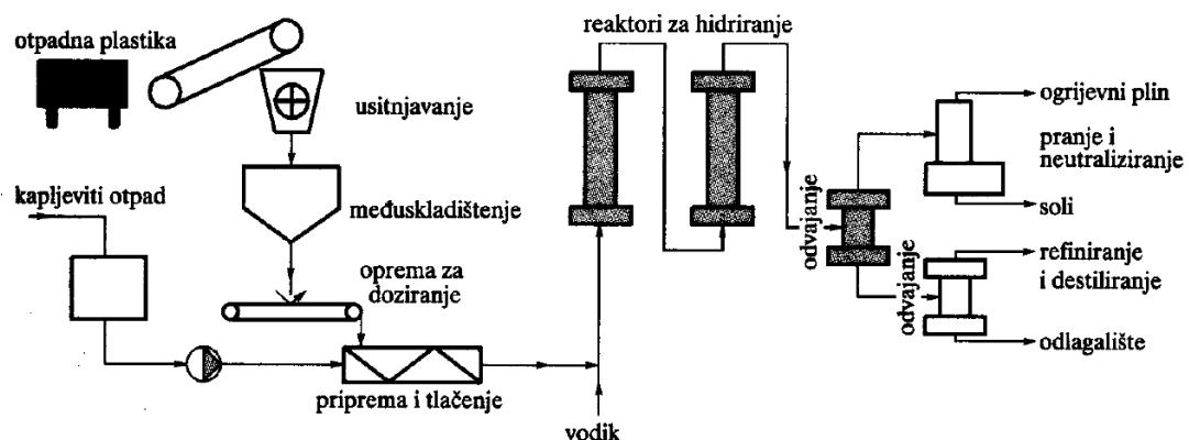
Slika 2.2 Shema postupka hidriranja otpadne plastike<sup>[4]</sup>
