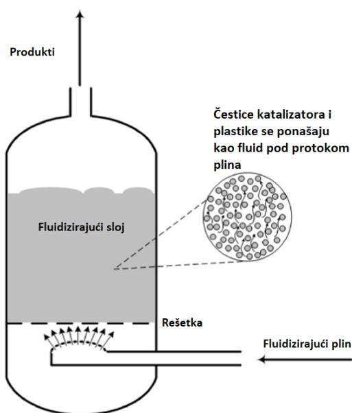
Slika 2.5 Shema reaktora za pirolizu u fluidizirajućem sloju<sup>[10]</sup>
