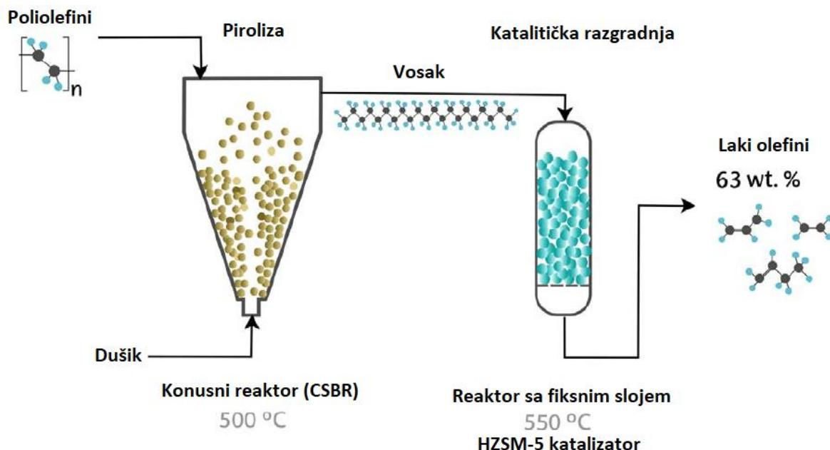
Slika 2.6 Shema pirolize poliolefina u konusnom reaktoru s integriranim procesom katalitičke razgradnje<sup>[12]</sup>
