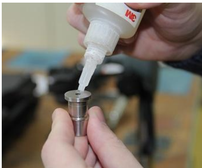
Slika 65. Nanošenje ljepila na ispitni valjak
