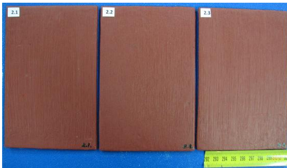
Slika 33. Ispitni uzorci zaštićeni Premzom AV 2
