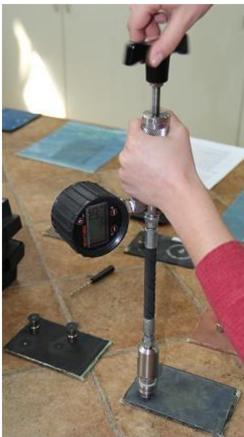
Slika 66. Postupak mjerenja adhezije premaza uređajem Elcometer 108
