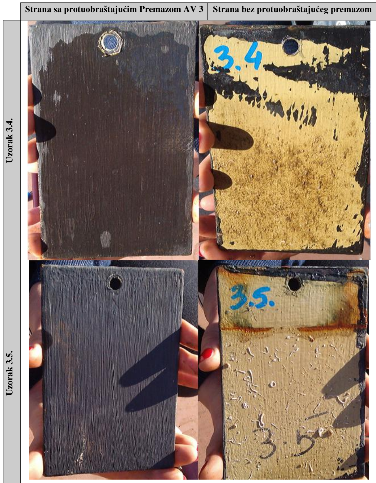
Slika 41. Uzorci 3.4. (izložen suncu) i 3.5. (u hladu) zaštićeni Premazom AV 3, mjesec dana nakon uranjanja u more
