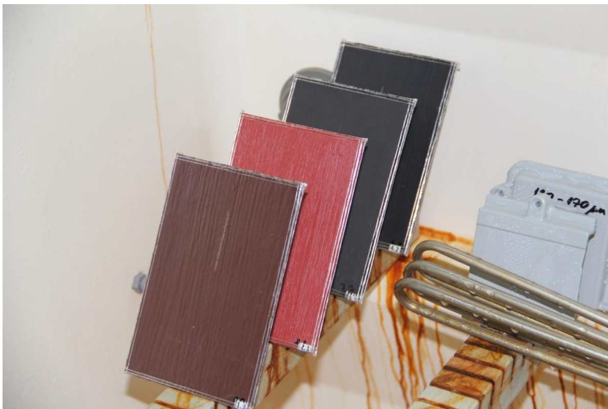
Slika 63. Uzorci u slanoj komori
