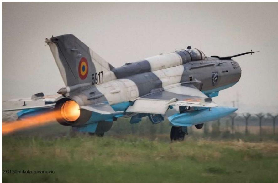
Slika 22. *MiG-21* uz korištenje naknadnog izgaranja
