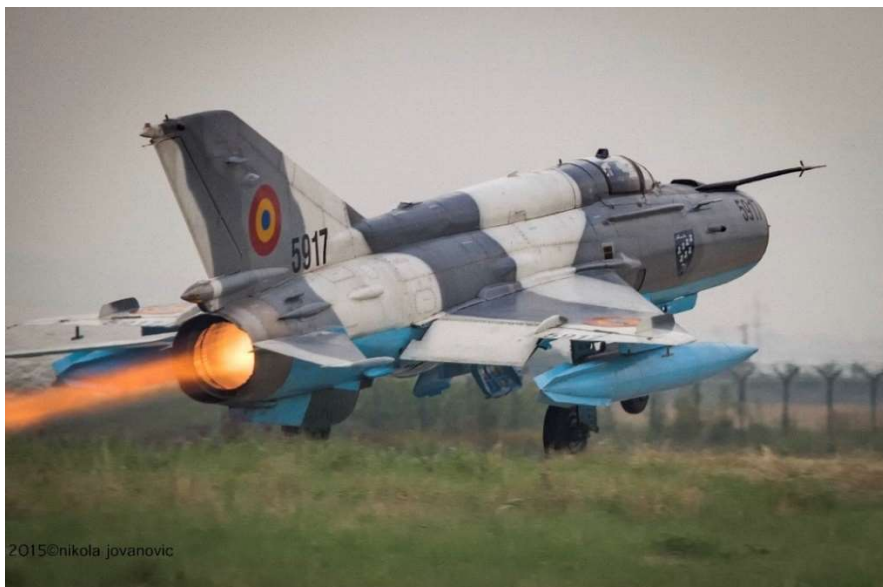
Slika 22. MiG-21 uz korištenje naknadnog izgaranja
