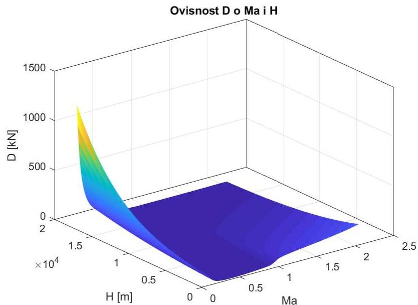
**Slika 8. 3D prikaz ovisnosti sile otpora o brzini i visini za MiG-21 bez raket**
