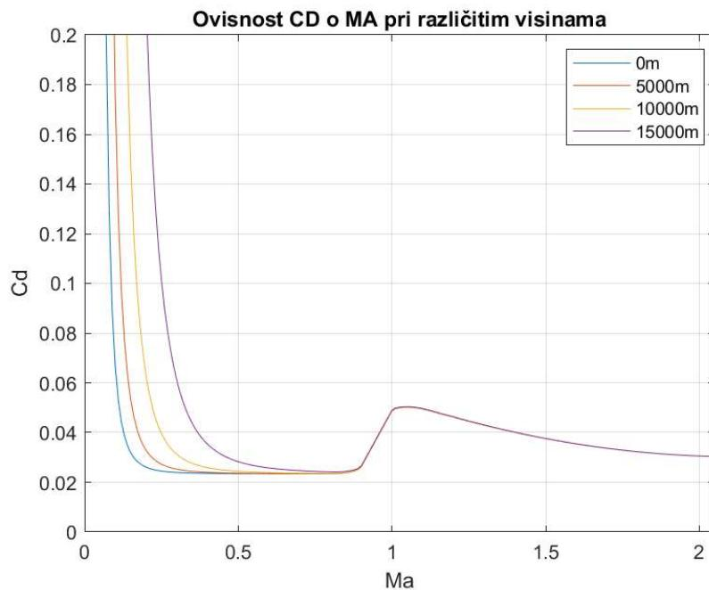
**Slika 7. Prikaz ovisnosti  $CD_0$  o  $Ma$  za MiG-21 bez raket**
