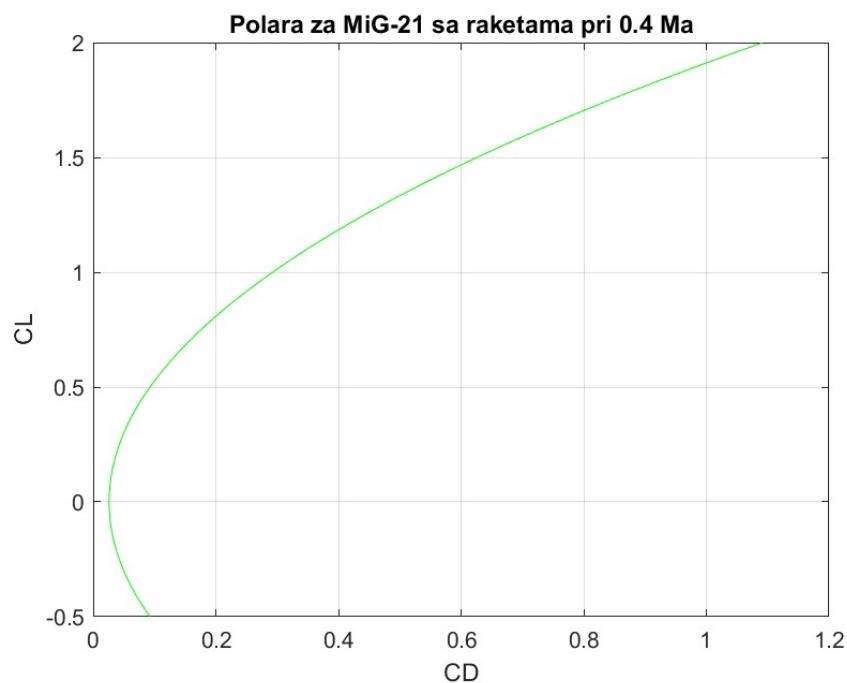
Slika 10. Polara za *MiG-21* sa dvije rakete pri  $0.4\text{Ma}$ , na visini  $15.2\text{m}$
