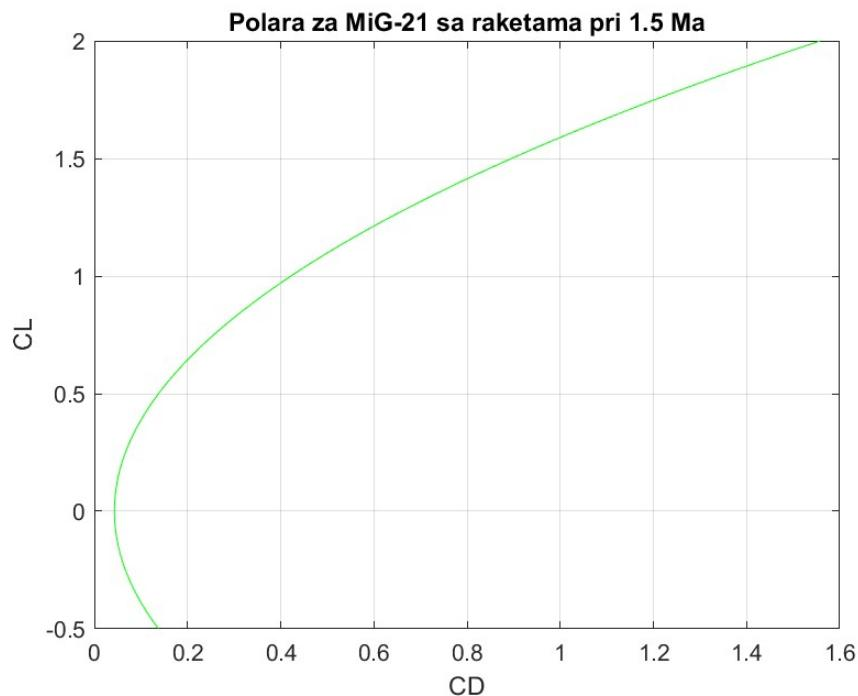
Slika 11. Polara za *MiG-21* sa dvije rakete pri  $1.5\text{Ma}$  na visini  $10000\text{m}$
