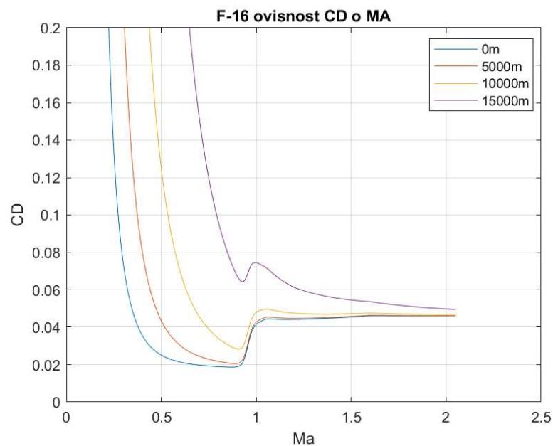
Slika 16. Ovisnost  $CD$  o  $Ma$  za  $F-16$
