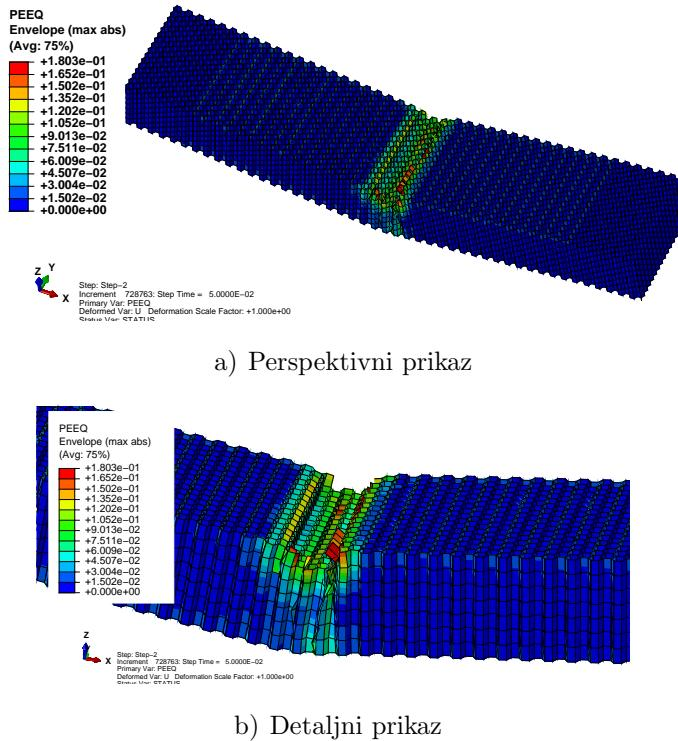
Slika 4.25: Ekvivalentne plastične deformacije saćastog modela jezgre [-]
