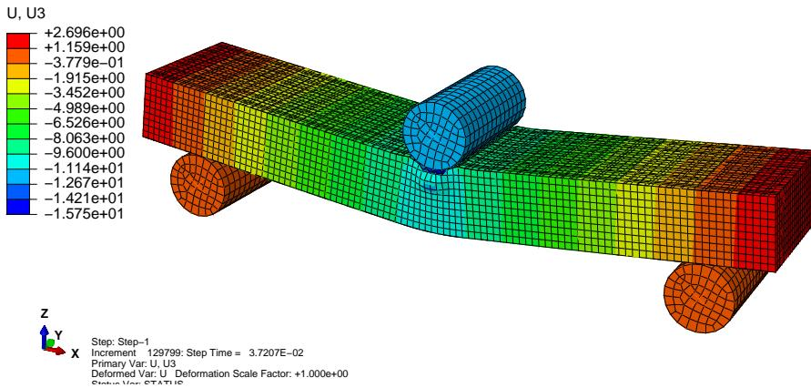
Slika 4.2: Prikaz konačnog položaja homogeniziranog modela, pomaci [mm]
