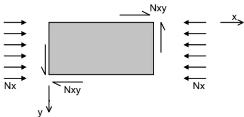
Slika 2.6: Smično i tlačno opterećena sendvič konstrukcija [2]
