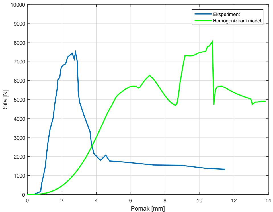
Slika 4.1: Ovisnost sile o pomaku homogeniziranog modela
