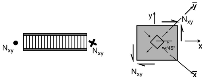
Slika 2.9: Lokalno izvijanje smično opterećene sendvič konstrukcije [2]
