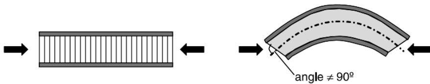
Slika 2.3: Savijanje sendvič panela uslijed tlačnog opterećenja [2]
