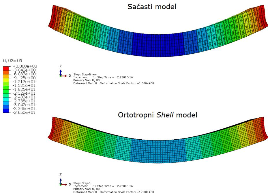
Slika 3.11: Pomaci materijalnih modela sa *Shell* vanjskim slojevima
