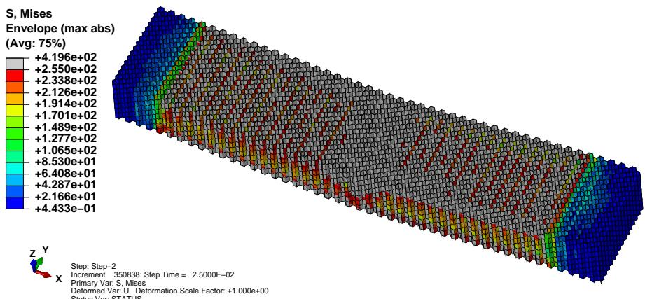
Slika 4.22: Naprezanja prema Von Misesu na 50% analize, [MPa]
