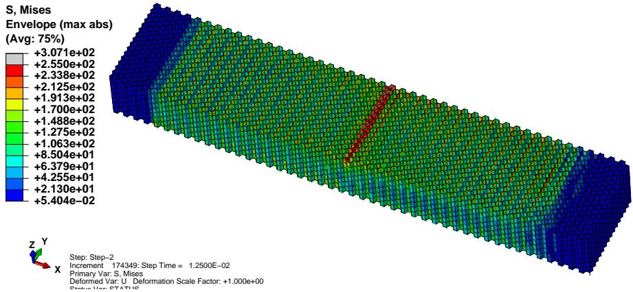
Slika 4.21: Naprezanja prema Von Misesu na 25% analize, [MPa]
