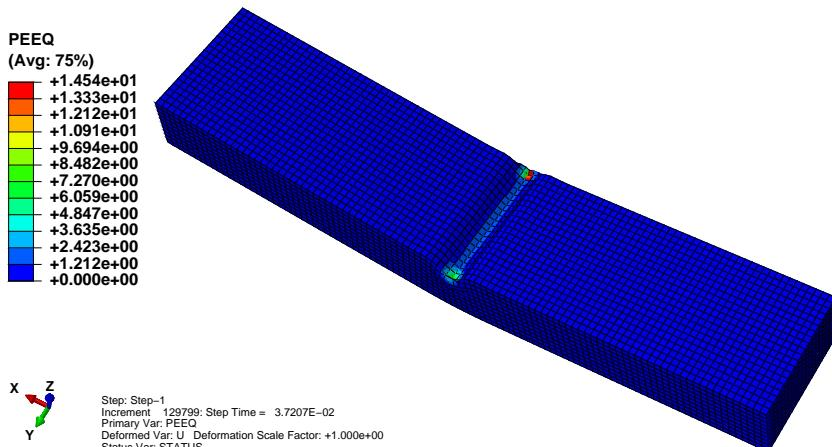
Slika 4.11: Trajne deformacije jezgre homogeniziranog modela [-]
