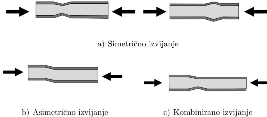
Slika 2.7: Tipovi lokalnog izvijanja [2]
