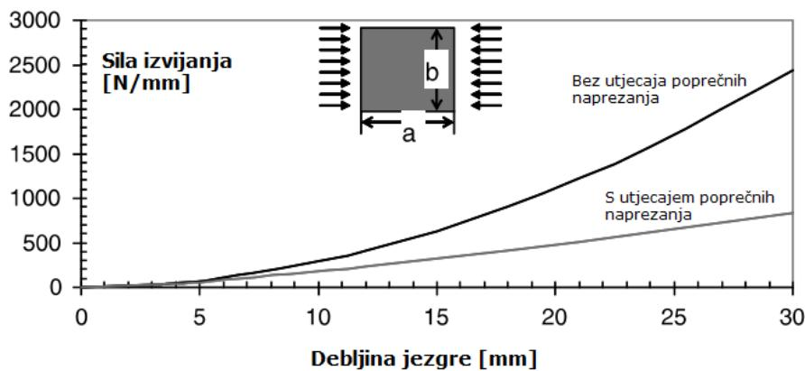
Slika 2.4: Izvijanje sa i bez utjecaja poprečnih naprezanja [2]
