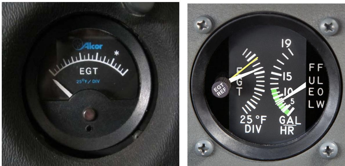
Slika 3.7. Lijevo: analogni EGT prikaznik. Desno: analogni prikaznik EGT i FF [6]
