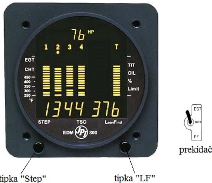
Slika 6.1. Prikaznik uređaja EDM-800 [9]
