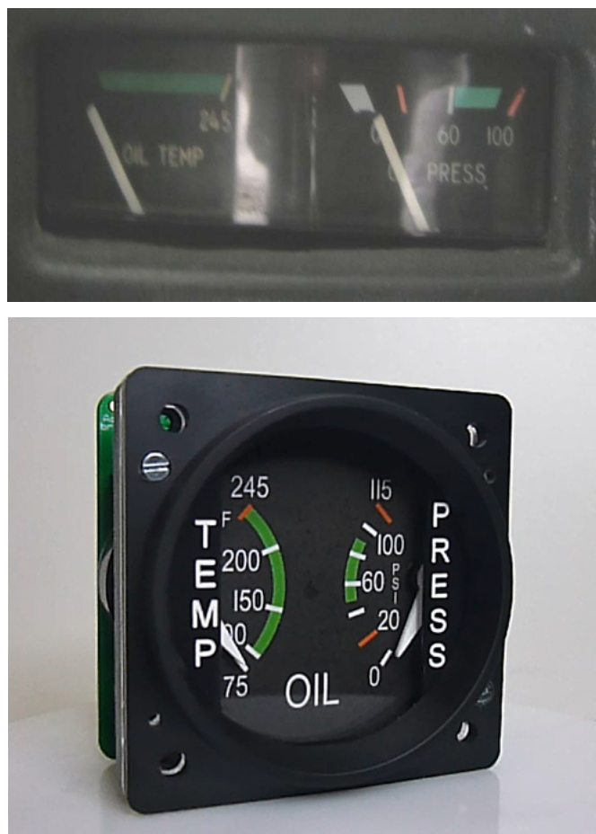
Slika 3.9. Analogni prikaznici tlaka i temperature ulja [7]
