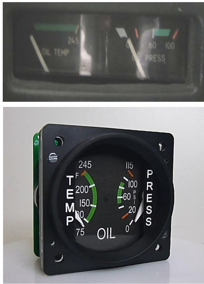
Slika 3.9. Analogni prikaznici tlaka i temperature ulja [7]
