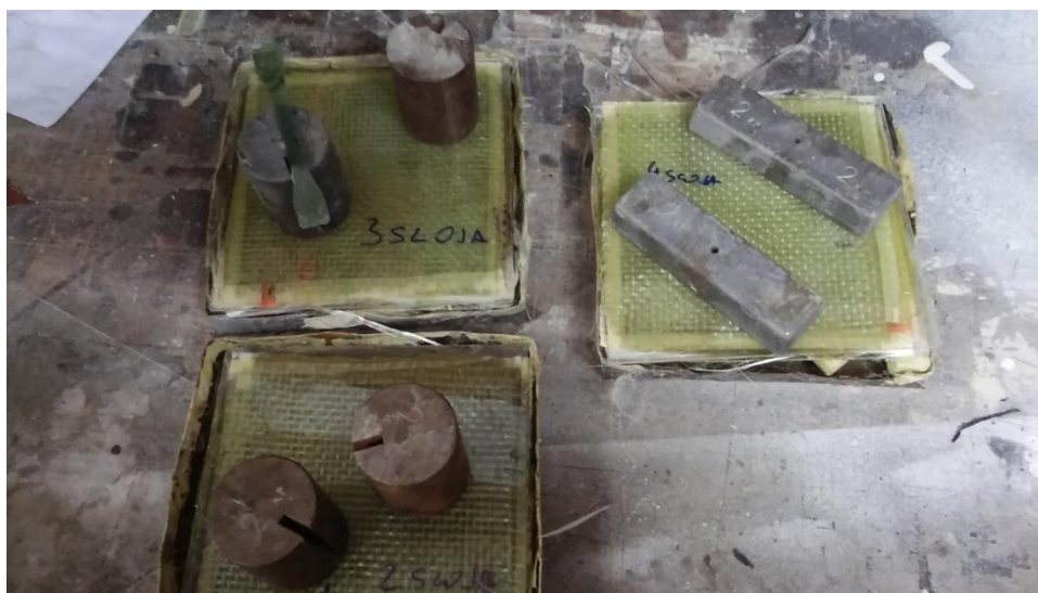
Slika 32. Opterećeni komadi kompozita
