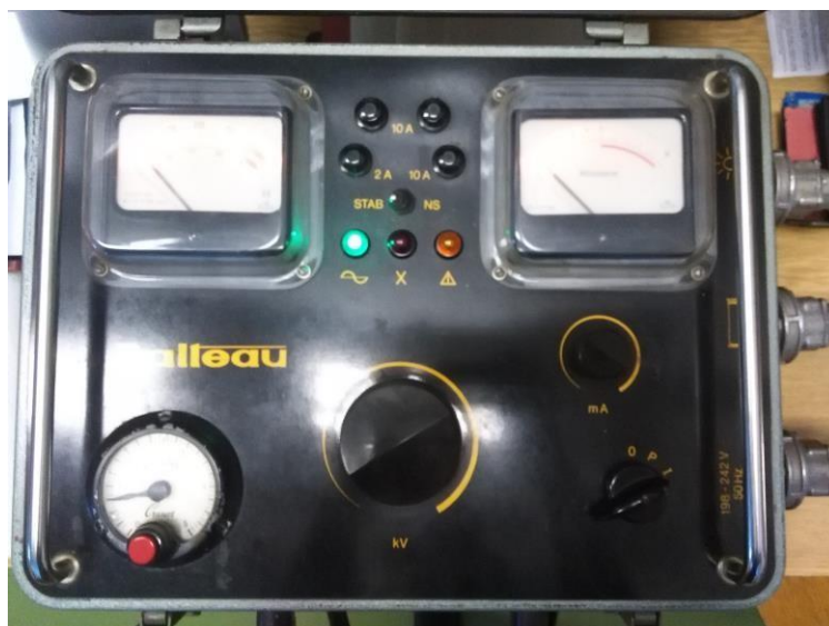
Slika 12: Upravljačka ploča s regulatorima za napon, struju i vrijeme
