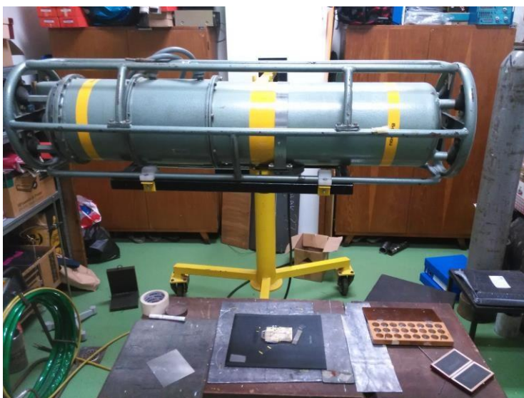
Slika 10: Rendgenska cijev na nosaču postavljena na 700 mm visine
