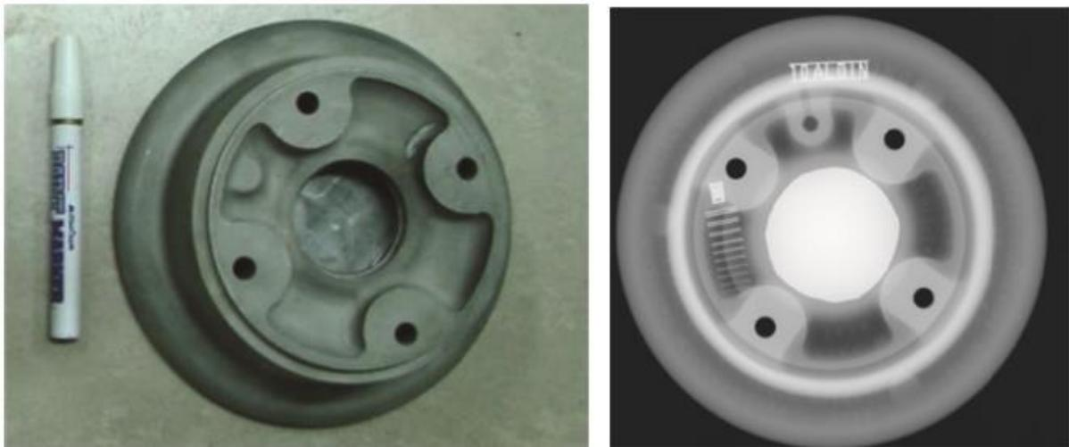
Slika 5: Stajni trap zrakoplova Falcon-20 i CR snimka [7]
