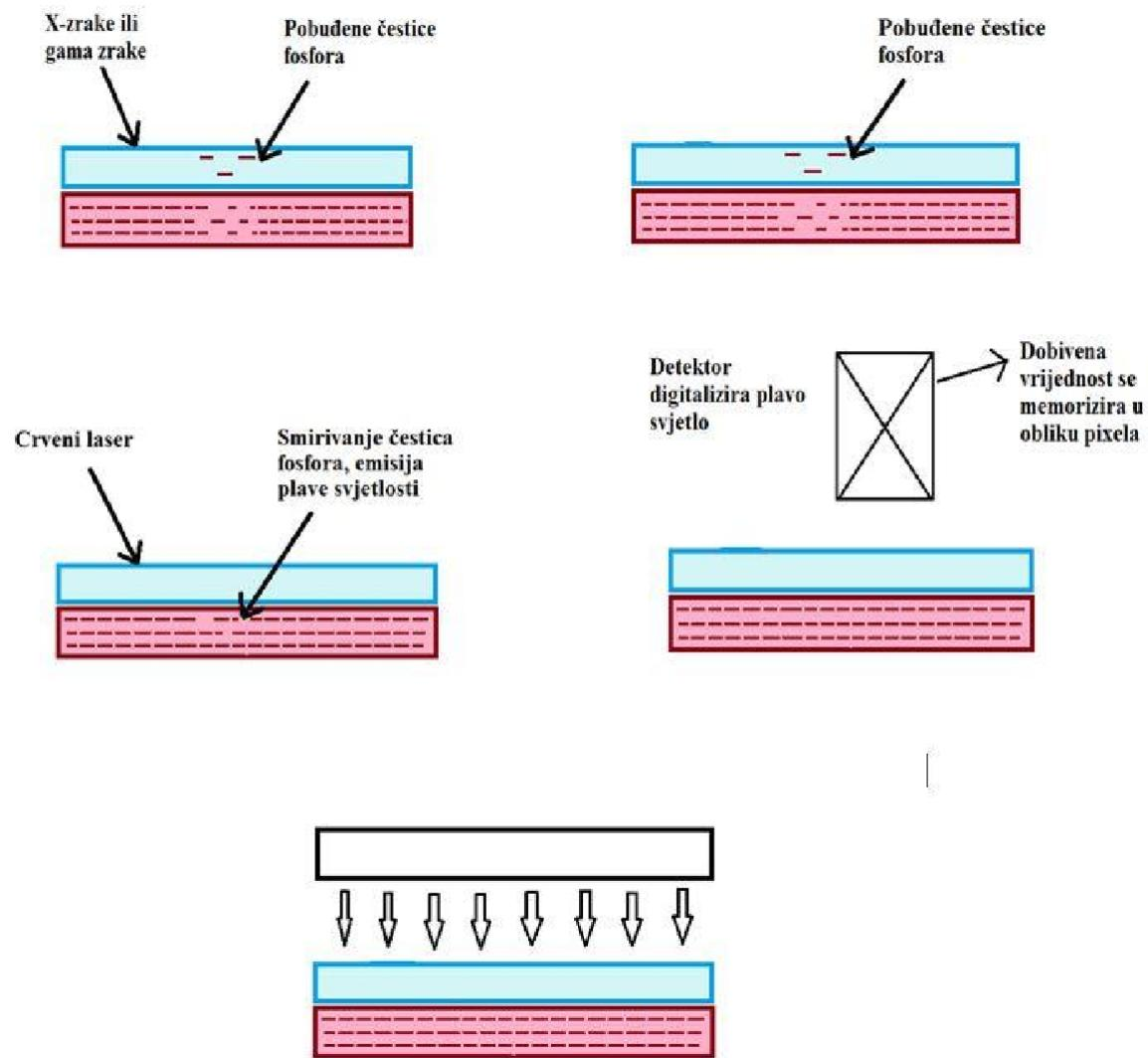
Slika 2: Princip rada metodom računalne radiografije [5]
