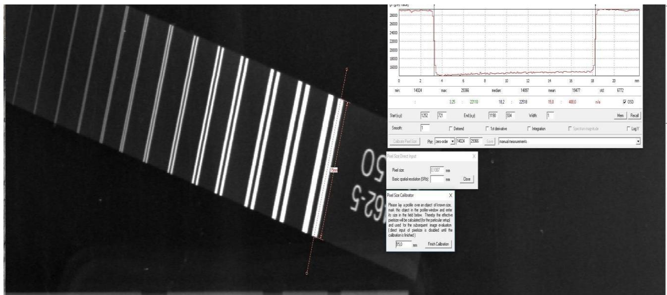
Slika 18: Kalibracija veličine piksela temeljem referentne duljine žice
