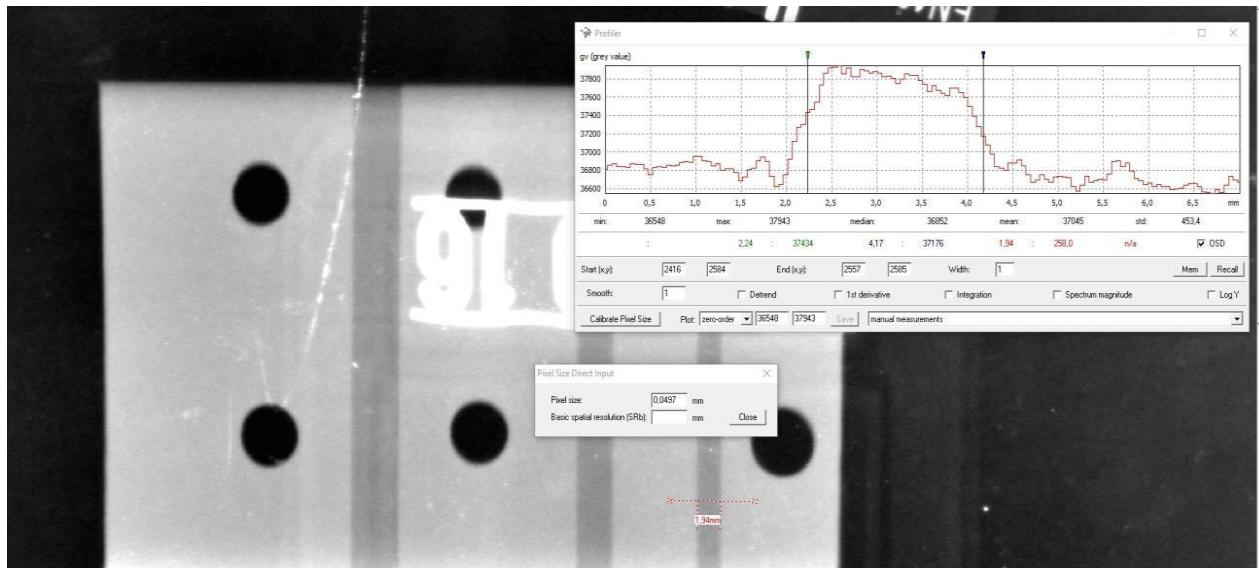
Slika 19: GP radiogram-mjerenje širine utora Uzorka 1
