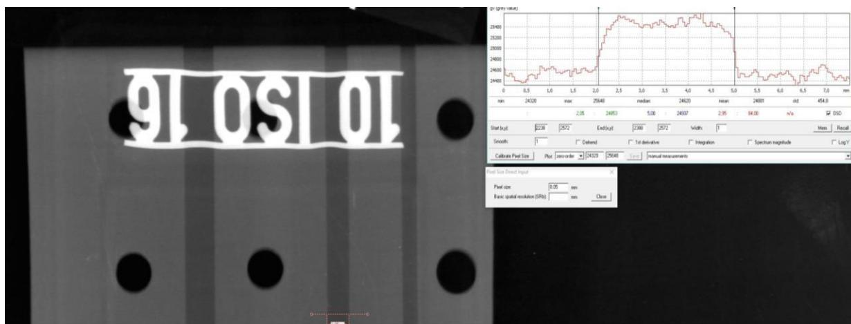
Slika 22: Mjerjeњe širine utora na Blue ploči Uzorka 1
