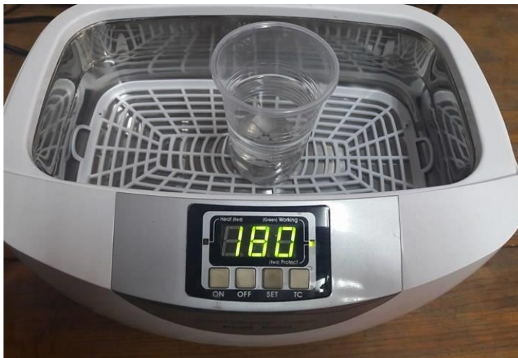
Slika 23 Otklanjanje nečistoća u ultrazvučnoj kadi
