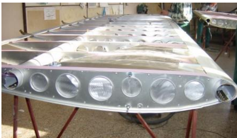
Slika 3 Dijelovi krila izrađeni od legura 7XXX [9]
