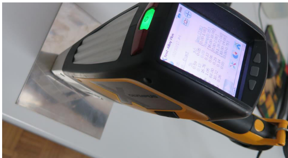
Slika 19: Prikaz provedbe ispitivanja kemijskog sastava XRF metodom.
