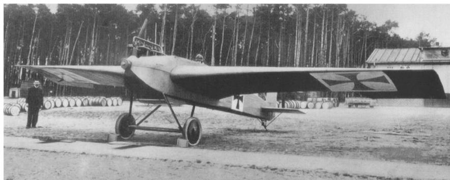
**Slika 2.** Junkers J-1 prvi avion potpuno metalne konstrukcije
