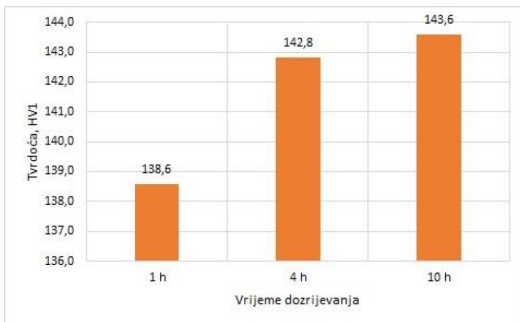
**Slika 31.** Vrijednosti tvrdoće uzoraka dozrijevanja na 160°C nakon homogenizacije pri 525°C/1h
