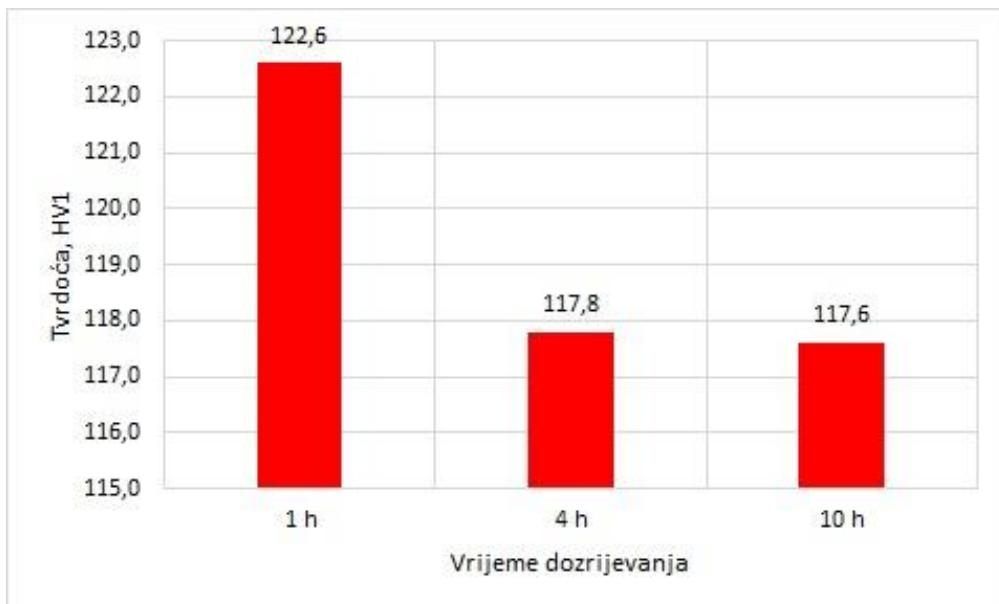
**Slika 37.** Vrijednosti tvrdoće uzorka dozrijevanja na 190°C nakon homogenizacije pri 560°C/2h
