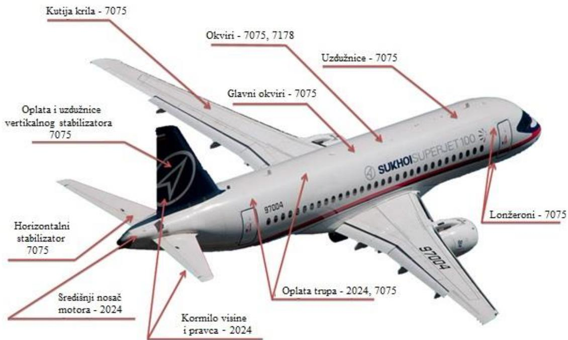
**Slika 15.** Primjena aluminija u zrakoplovnim konstrukcijama
