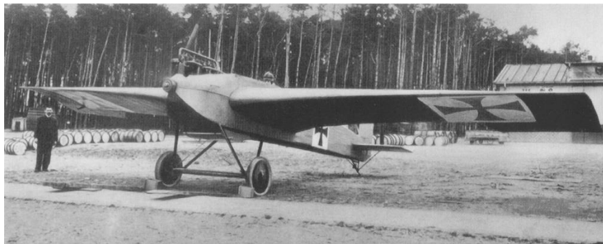
Slika 2. Junkers J-1 prvi avion potpuno metalne konstrukcije
