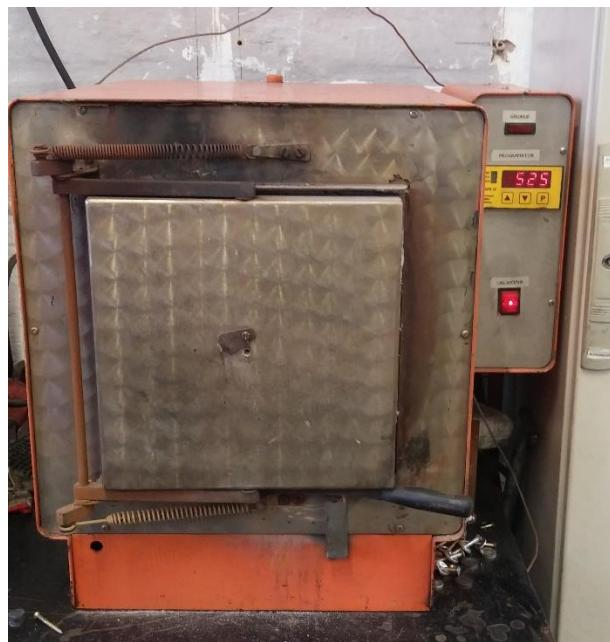
**Slika 27.** Elektropeć-otporna peć za toplinsku obradu
