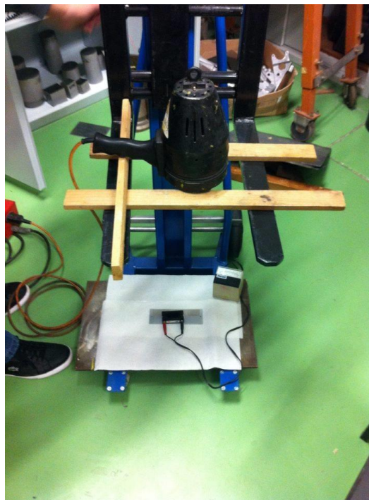
Slika 8. Izgled ispitnog postava za ispitivanje zajedno s UVmetrom
