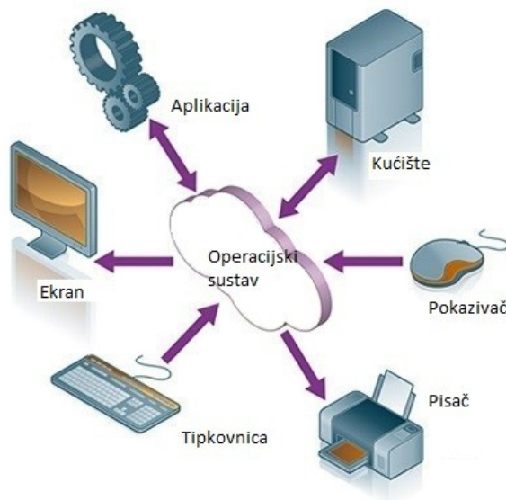
Slika 2. Upravljanje komponentama pomoću operacijskog sustava [4]
