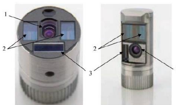
Slika 11. Distalni završeci za ravno i kutno snimanje; 1 – CCD kamera, 2 – rešetkasti uzorak, 3 – standardni osvjetljavajući sustav [10]
