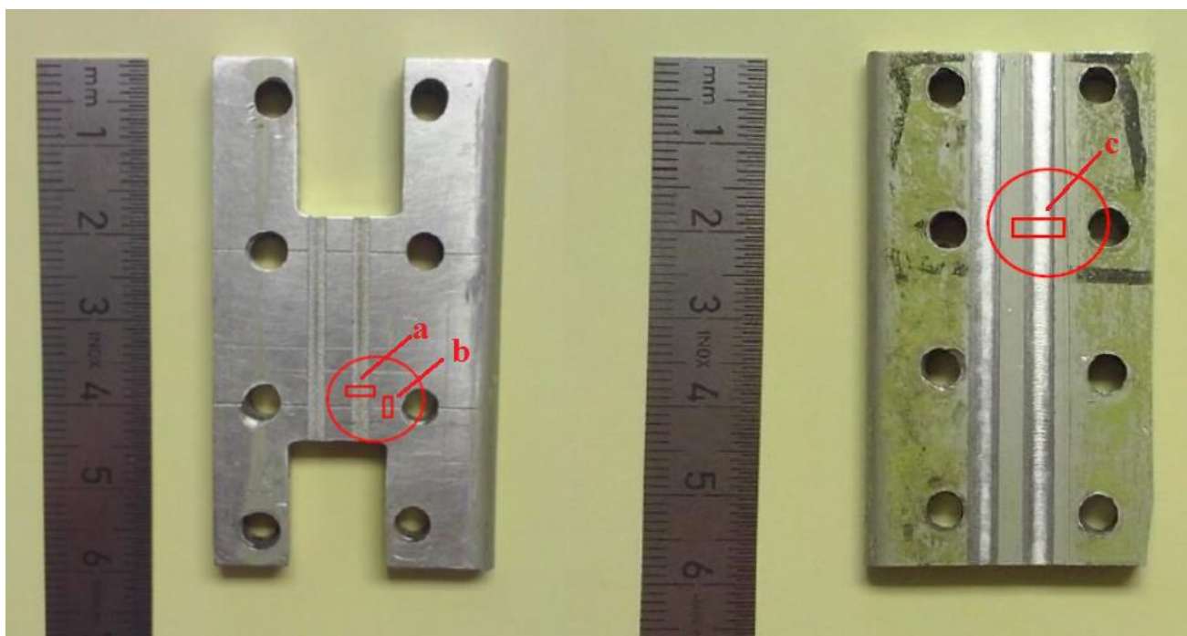
Slika 27. Uzorci 1 i 2 sa oznakama područja a, b, c na kojima se provodi dio ispitivanja (mjerno povećalo, 3D fazno mjerenje, stereo metoda mjerenja, računalna tomografija)
