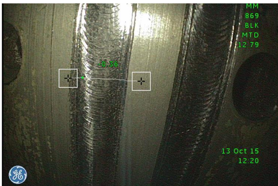
Slika 39. Očitavanje dubine oštećenja – point line, [mm]
