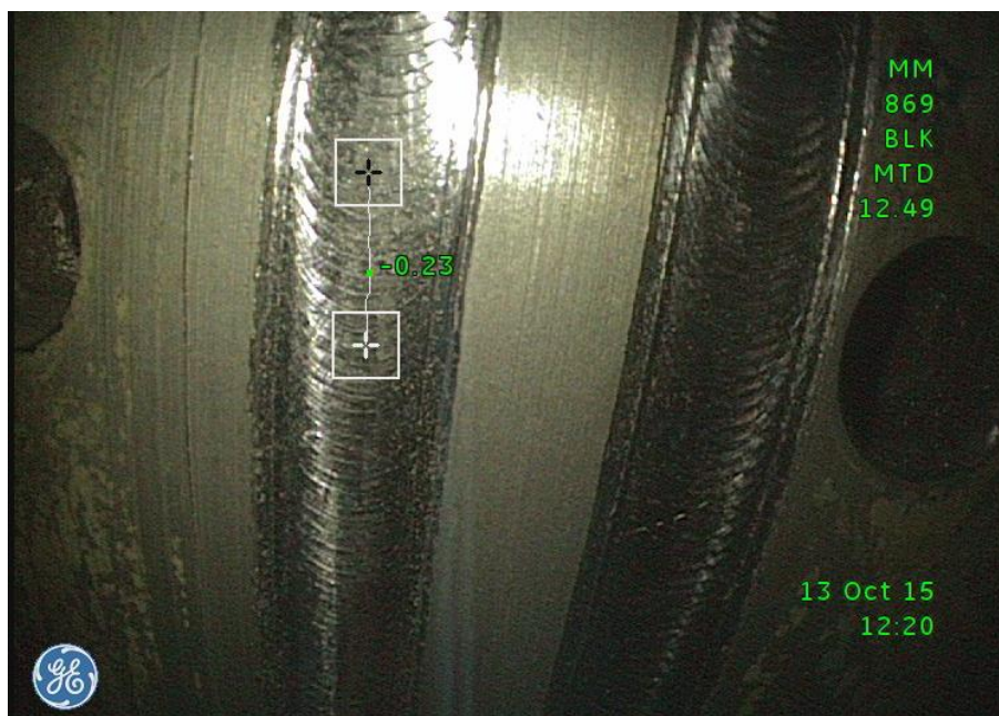
Slika 41. Očitavanje dubine oštećenja – point line, [mm]
