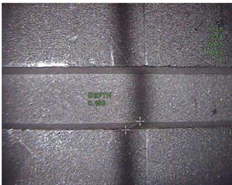
Slika 7. Primjer očitavanja dubine na objektu ispitivanja metodom sjenčanja [8]
