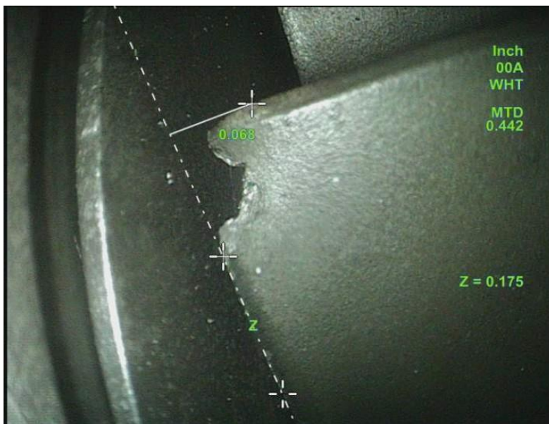
Slika 15. Primjer očitavanja udaljenosti definirane točke od nekog pravca [15]
