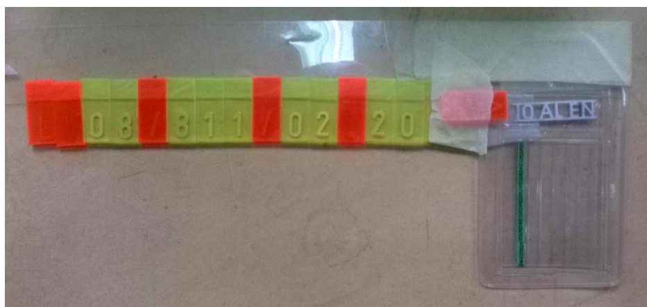
Slika 15. Indikatori kvalitete i identifikacijske oznake radiograma
