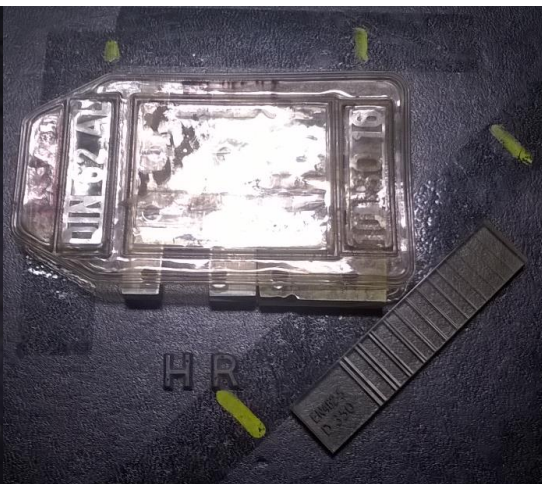
Slika 21. Postav Indikatora kvalitete
