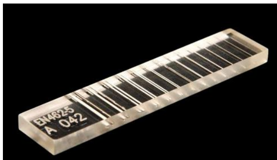
Slika 12. Indikator kvalitete s dvostrukim žicama [13]
