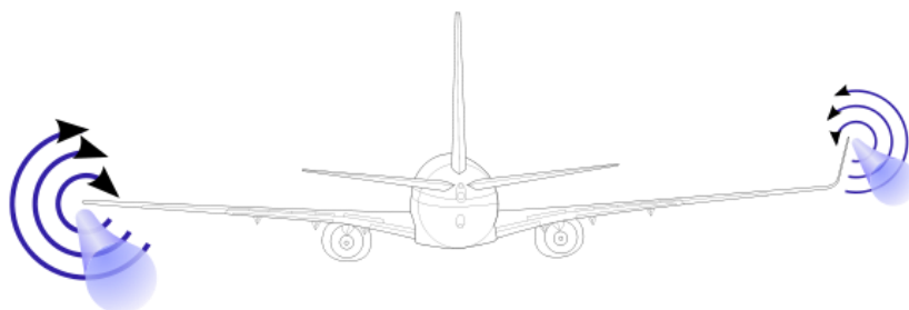
Slika 2. Intenzitet vršnog vrtloga pri različitim završecima krila [1]
