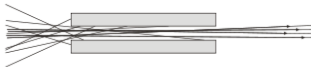
Slika 3.5. Utjecaj kolimatora na izlazne X zrake[6]
