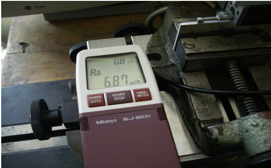
Slika 2.3 Prijenosni uređaj Mitutoyo SJ-201 za mjerenje hrapavosti
