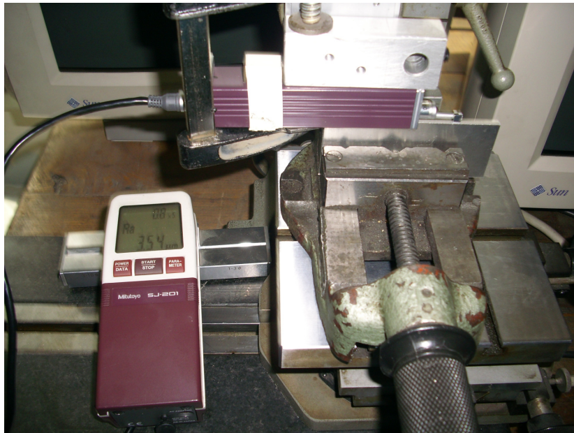
Slika 2.16 Prikaz mjerenja hrapavosti laserskih uzoraka
