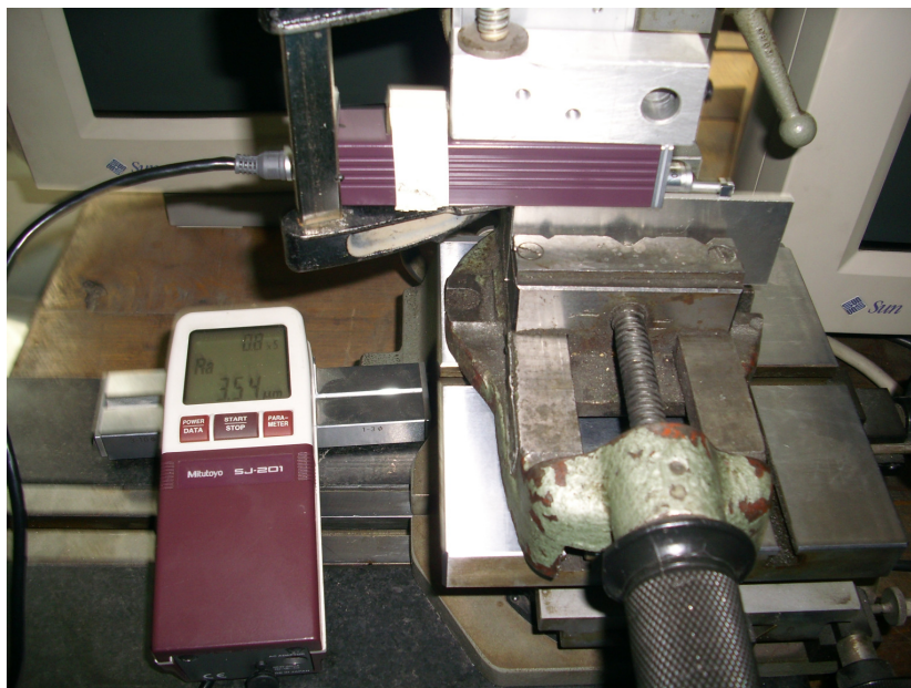
Slika 2.16 Prikaz mjerenja hrapavosti laserskih uzoraka
