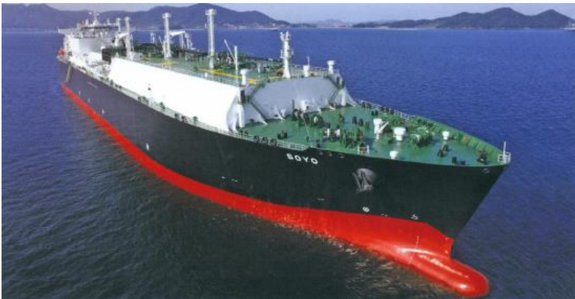
Slika 2.2. LNG brod sa membranskim spremnicima
