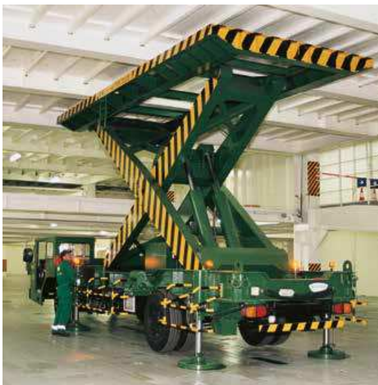
Slika 4. Mobilni škarasti lift [3]
