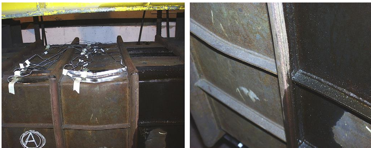
Slika 33. Deformacije oplate i ukrepa modela H300 nakon eksperimenta [4]
