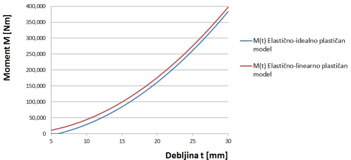
Slika 5.4. Ovisnost momenta o debljini obradka za čelik AH36 (2 modela)
