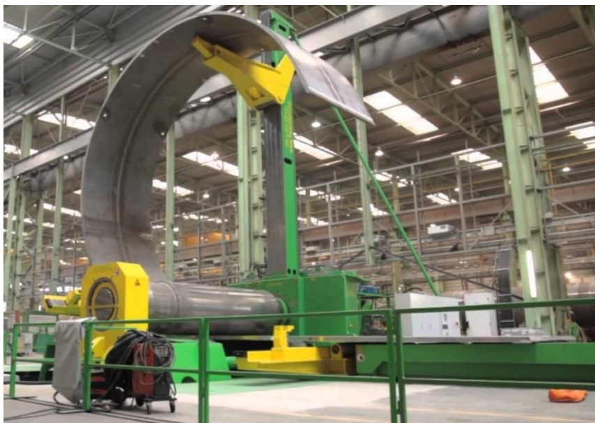
Slika 2.5 Suvremeni stroj s četiri valjka za elasto-plastično oblikovanje limova, [3]
