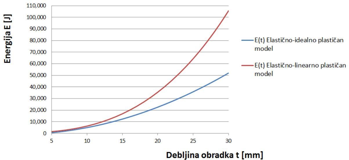
Slika 5.14. Ovisnost energije o debljini obradka za čelik ST24 (2 modela)
