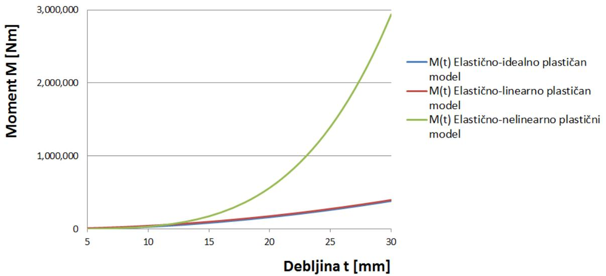
Slika 5.3. Ovisnost momenta o debljini obradka za čelik AH36 (3 modela)
