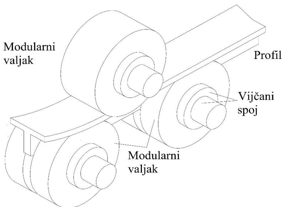
Slika 2.9 Osnovni princip rada stroja za oblikovanje profila, [1]
