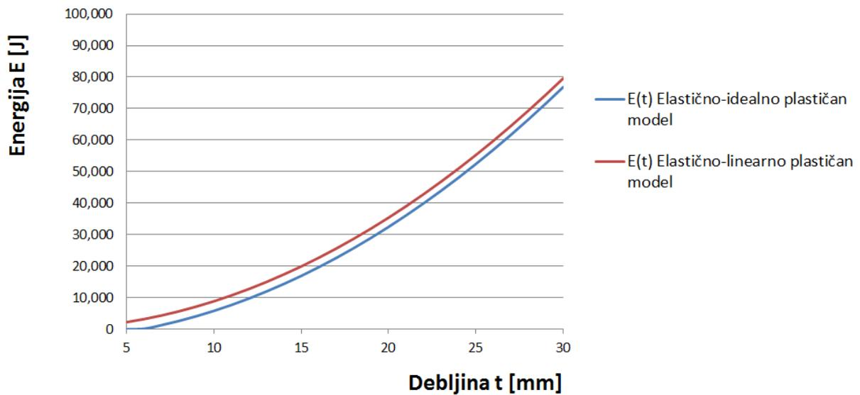
Slika 5.16. Ovisnost energije o debljini obradka za čelik AH36 (2 modela)
