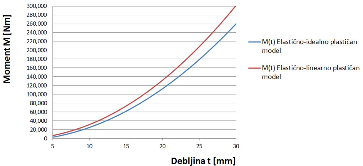
Slika 5.2. Ovisnost momenta o debljini obradka za čelik ST24 (2 modela)
