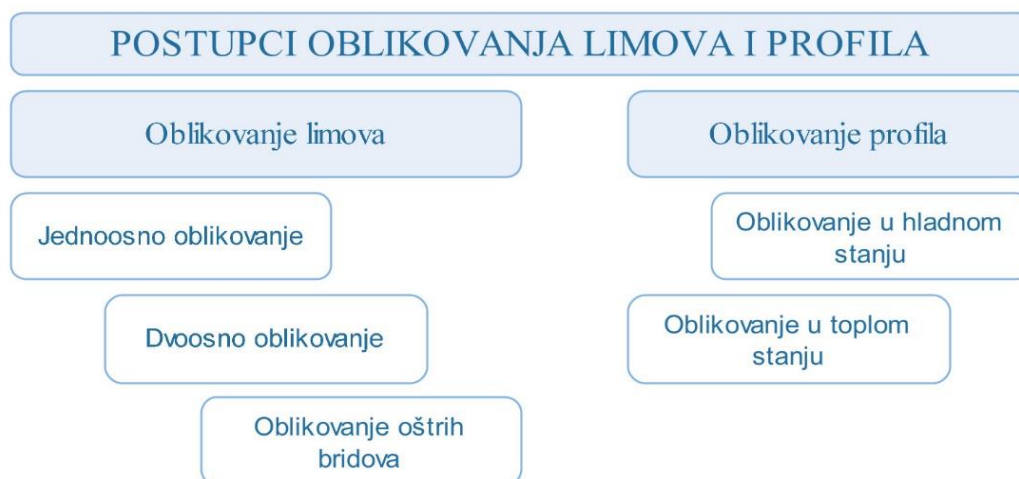
Slika 2.1 Klasifikacija postupaka oblikovanja limova i profila, [1]
