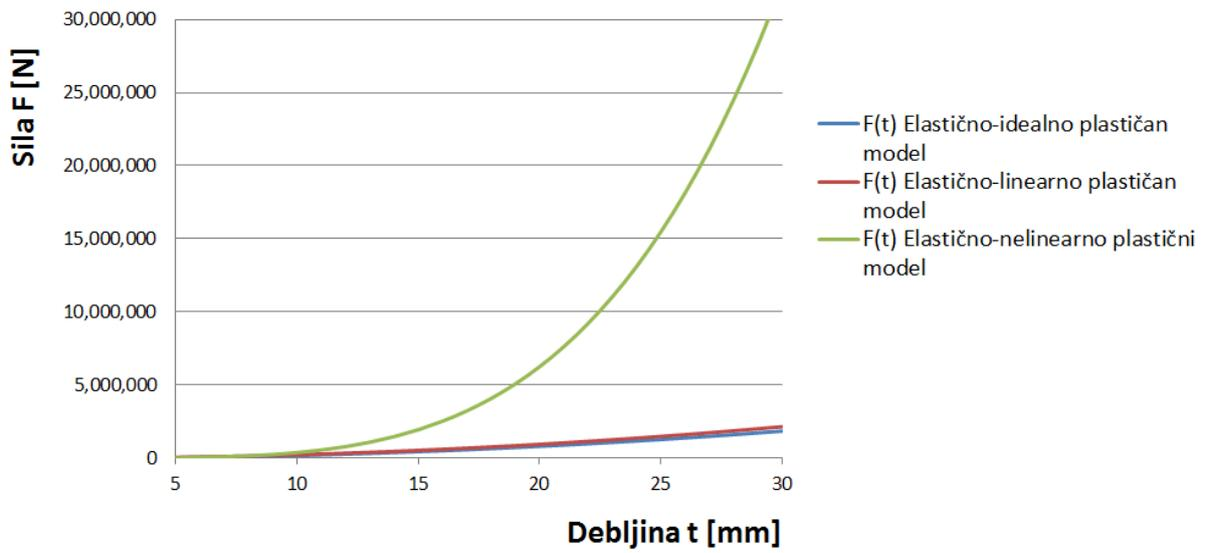
Slika 5.7. Ovisnost sile o debljini obradka za čelik ST24 (3 modela)
