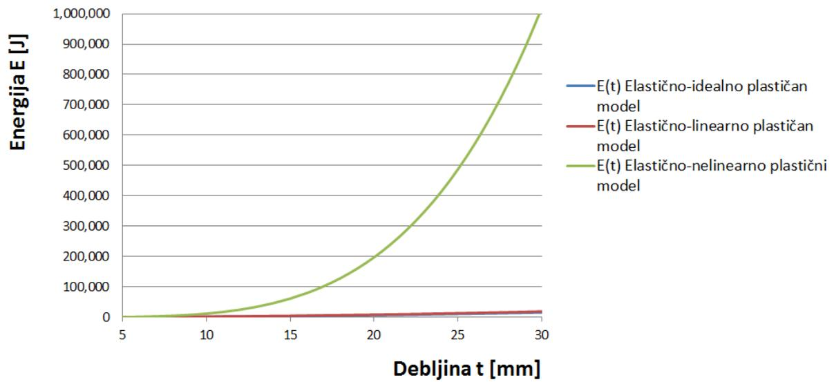
Slika 5.17. Ovisnost energije o debljini obradka za aluminij (3 modela)
