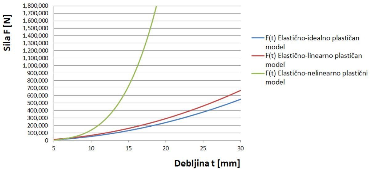
Slika 5.11. Ovisnost sile o debljini obradka za aluminij (3 modela)
