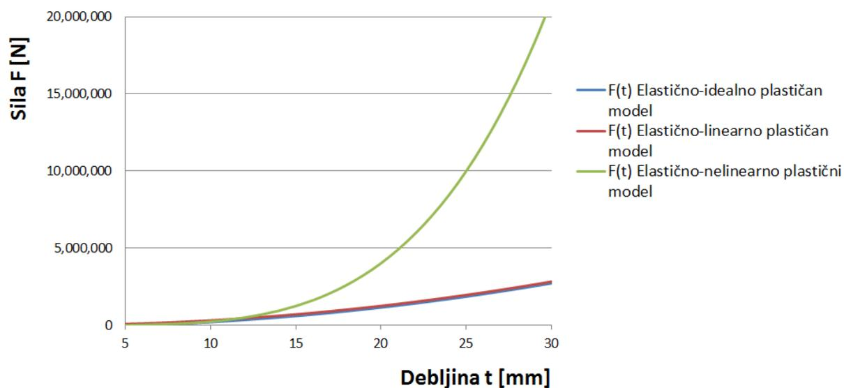
Slika 5.9. Ovisnost sile o debljini obradka za čelik AH36 (3 modela)
