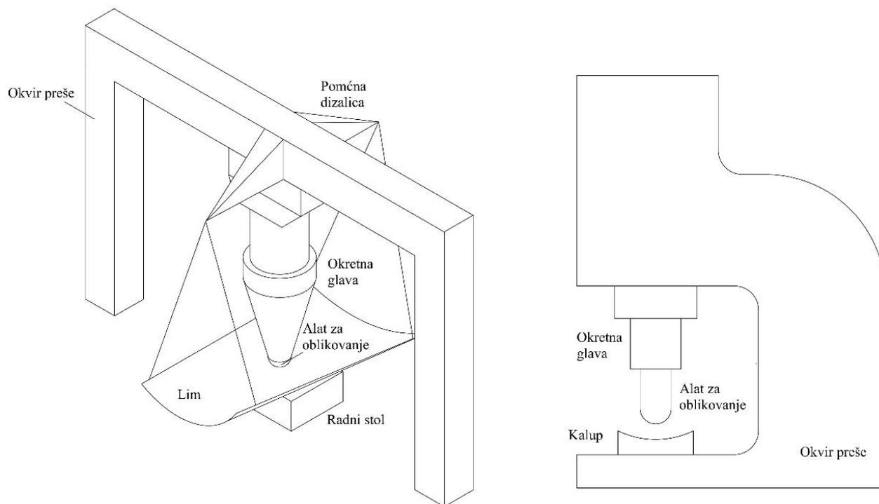
Slika 2.7 Shematski prikaz dvostupne i jednostupne preše, [1]
