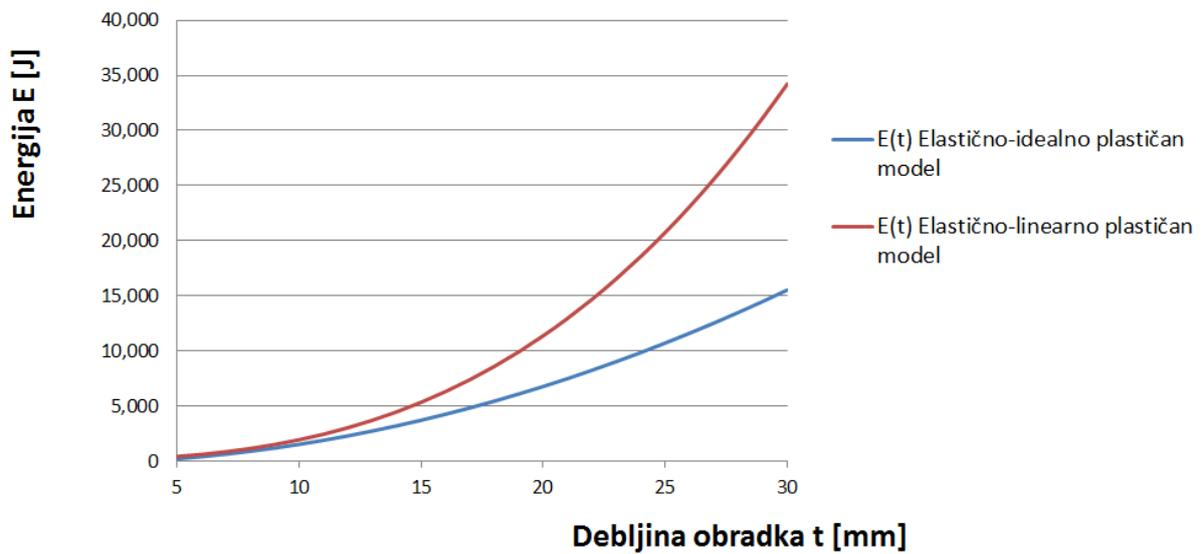
Slika 5.18. Ovisnost energije o debljini obradka za aluminij (2 modela)
