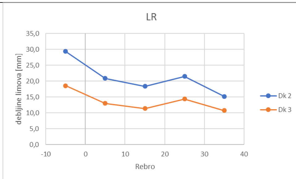
Slika 35. Promjena debljina limova po visinama prema LR-u
