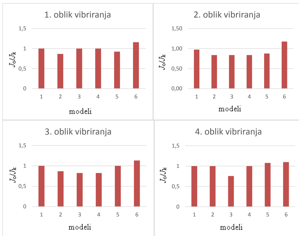
Slika 18. Dijagrami prvog, drugog, trećeg i četvrtog oblika vibriranja za šest modela u ovisnosti o omjeru J_0/J_k
