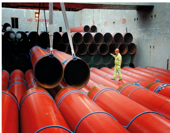
Slika 26. Prikaz užetom zavezanih cijevi i dizaličnog iskrcaja [23]
