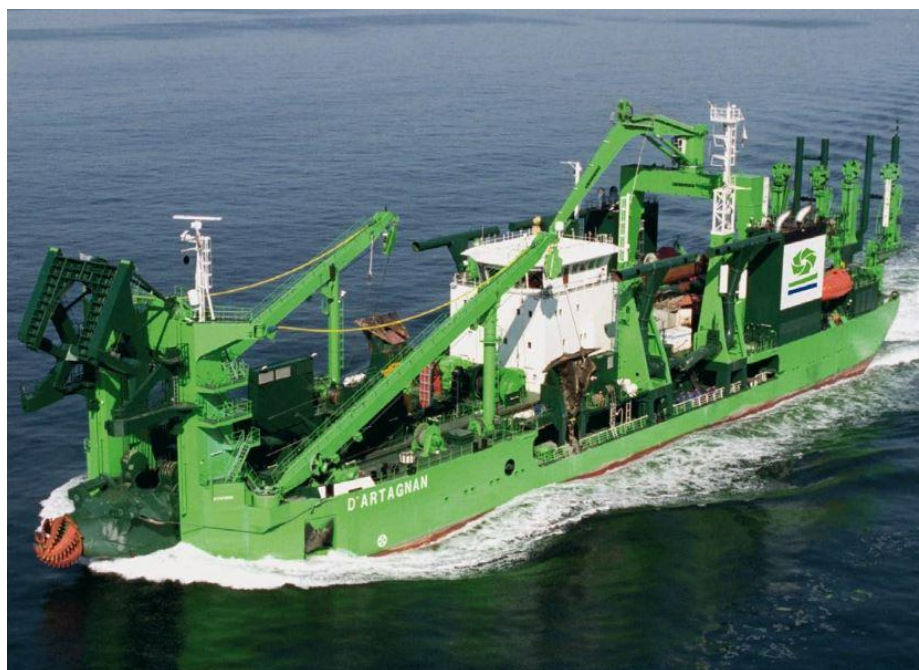
Slika 4 Usisno jaružalo opremljeno sjekačem
