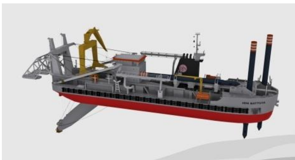
Slika 10 Model jaružala opremljenog sjekačem [2]
