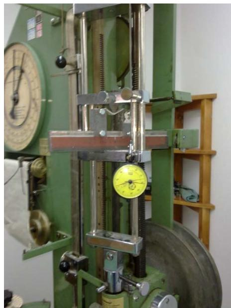
Slika 32 - Uređaj za ispitivanje savojne čvrstoće
