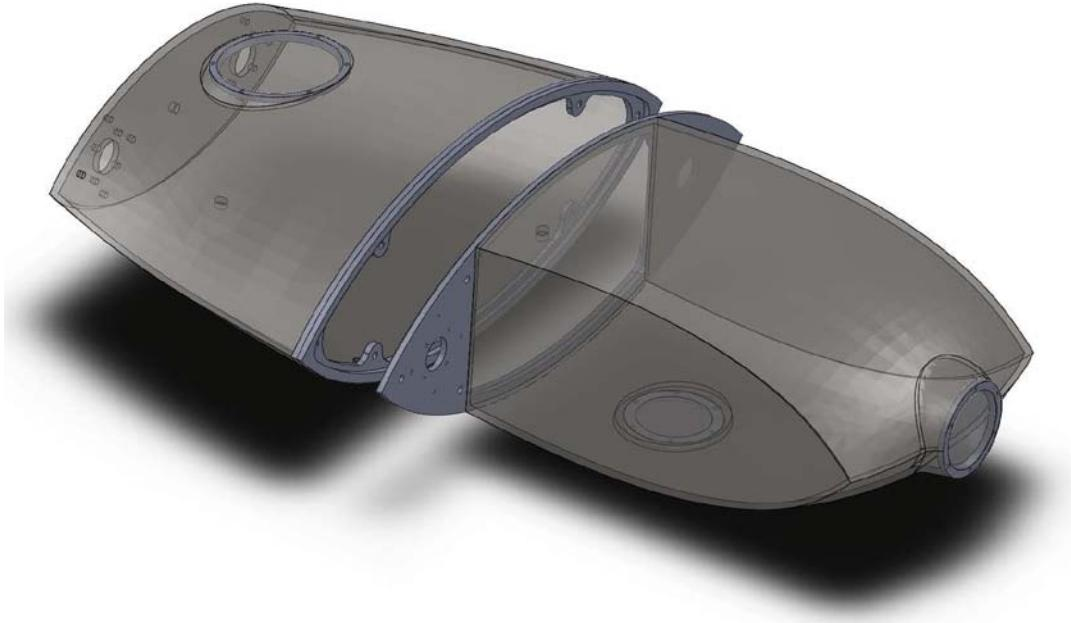
Slika 4 – Otvoreni SolidWorks sklop ronilice
