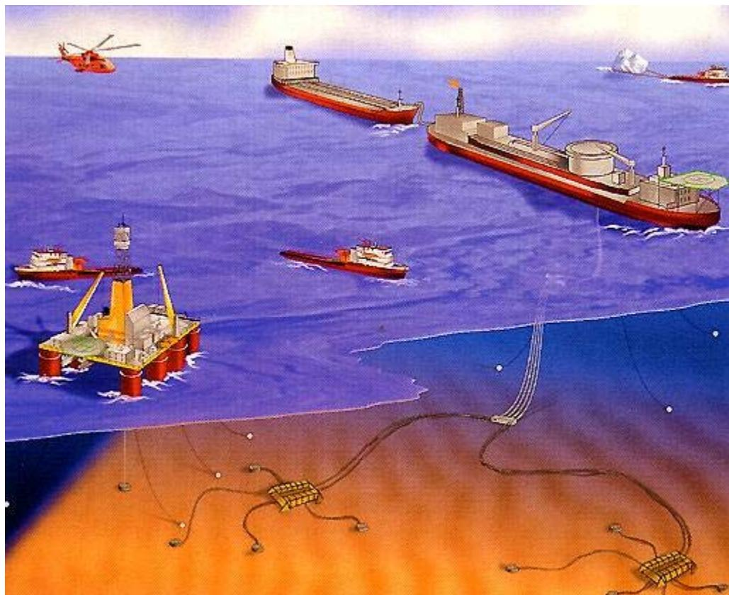
Slika 5. Shematski prikaz operativnog područja FPSO jedinice
