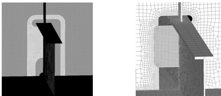
Slika 7. Načini pojačanja strukturalnih dijelova
