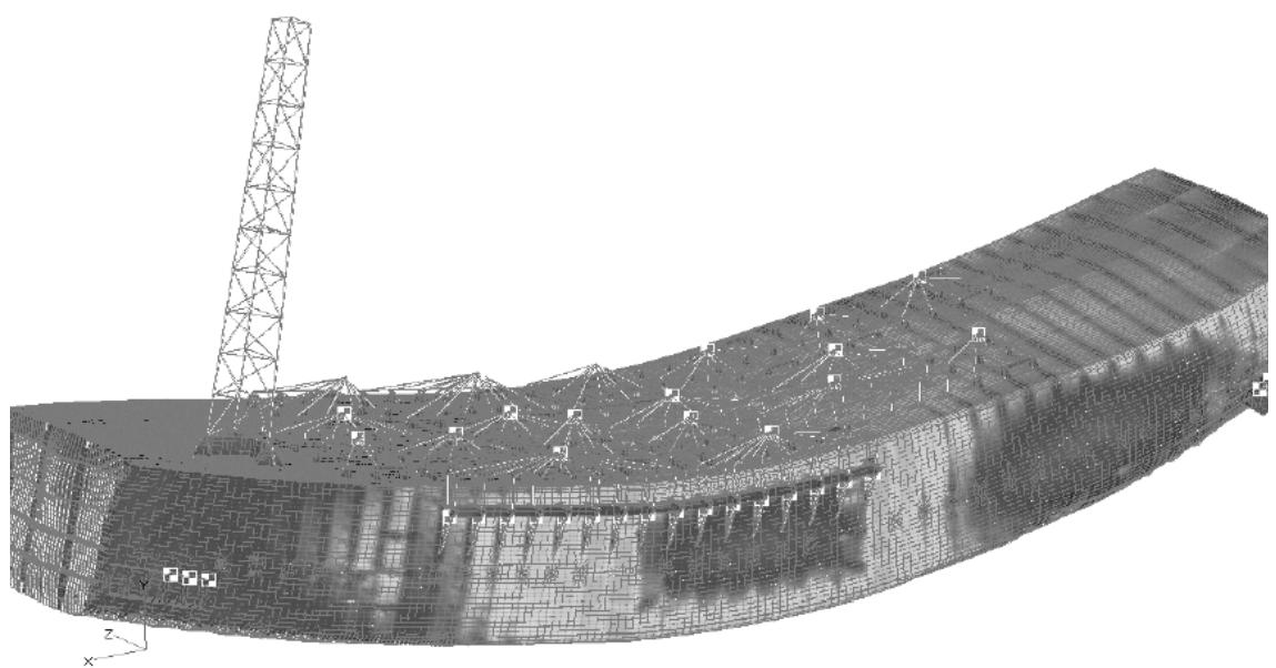
Slika 9. Odziv konstrukcije uslijed maksimalnog momenta savijanja
