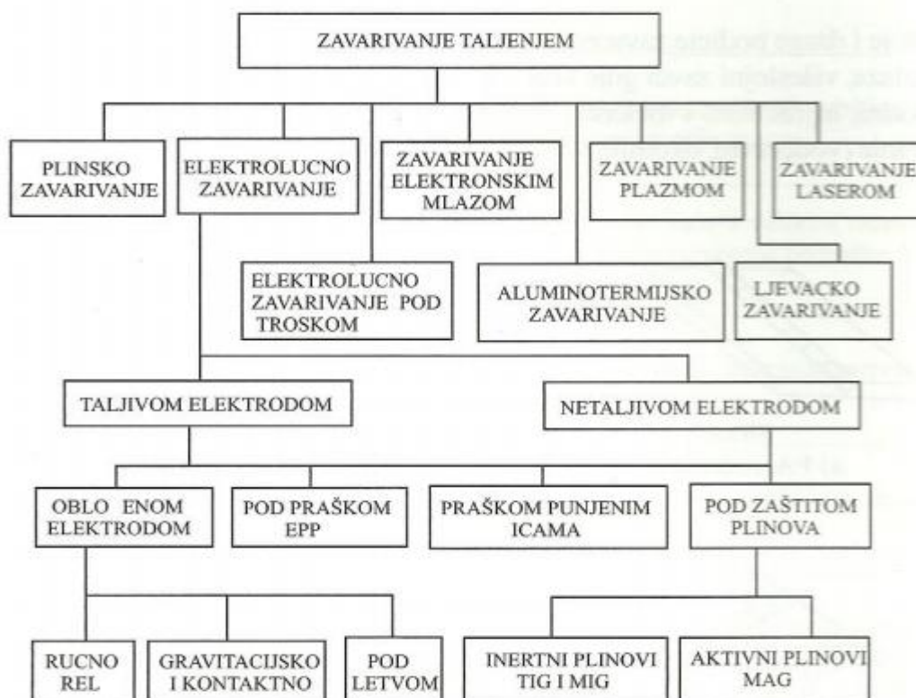
Slika 2. Podjela postupaka zavarivanja taljenjem
