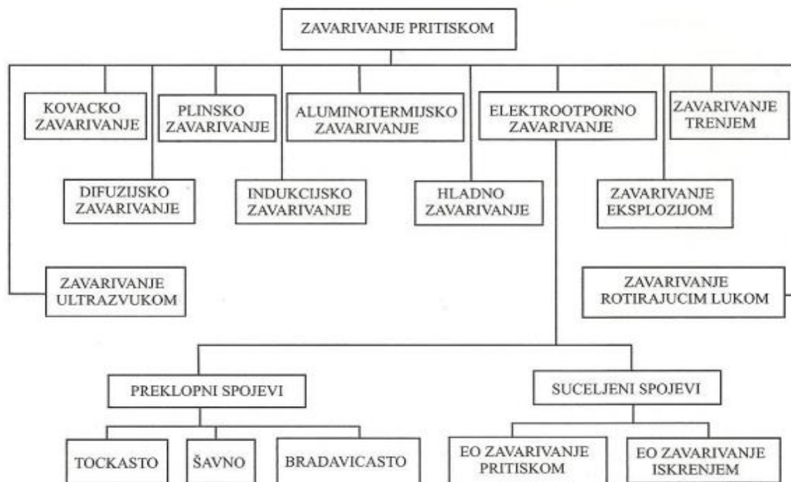
Slika 1. Podjela postupaka zavarivanja pritiskom
