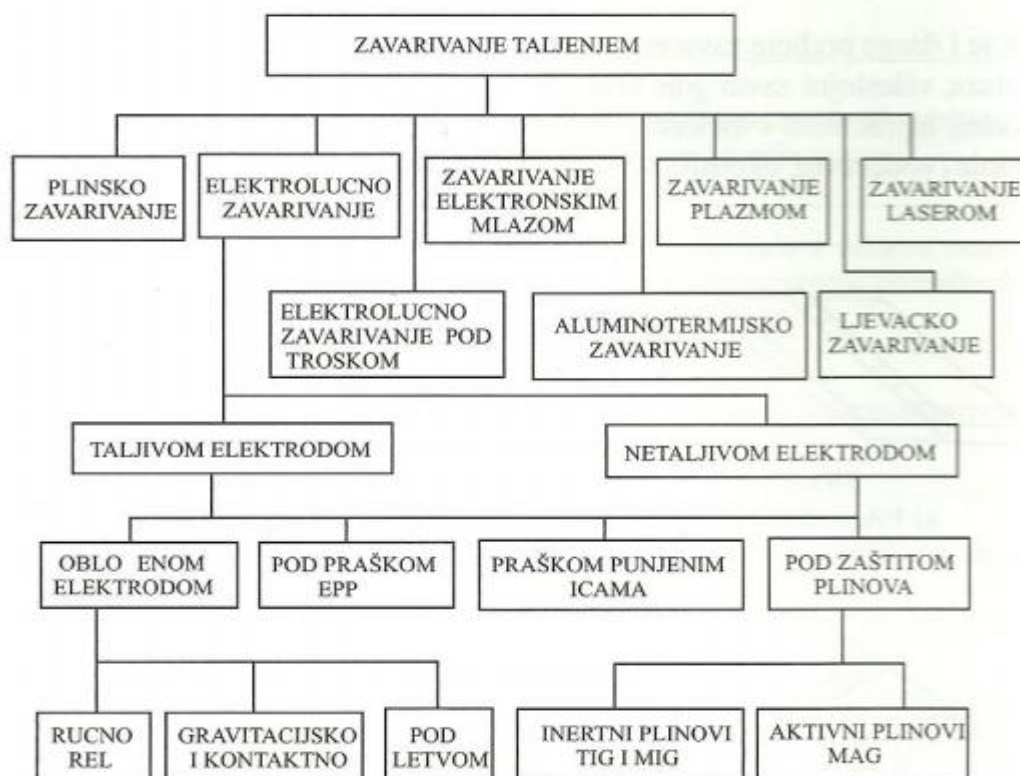
Slika 2. Podjela postupaka zavarivanja taljenjem
