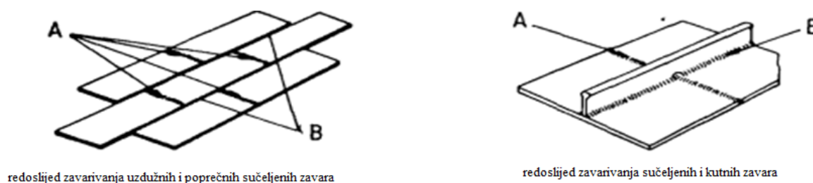
Slika 15. Prikaz redoslijeda zavarivanja
