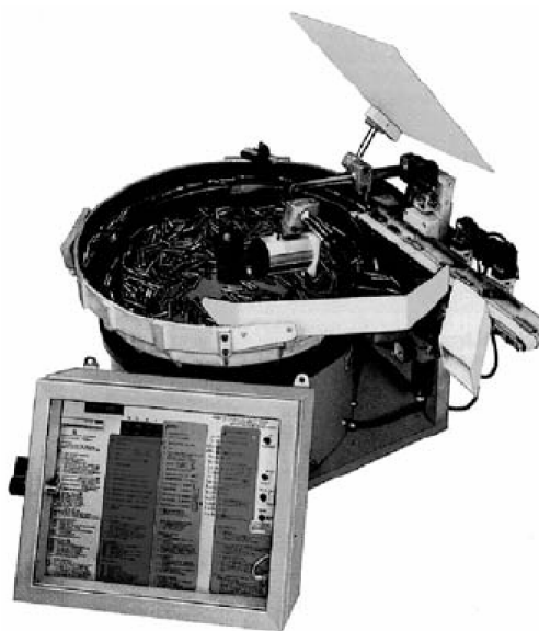
Slika 6.2. Dodavač sa sustavom za prepoznavanje proizvoda
