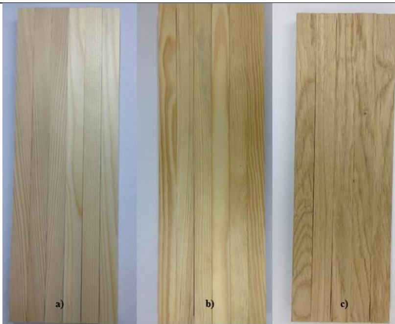
Slika 34. Prikaz epruveta: a) Bor b) Jela c) Hrast
