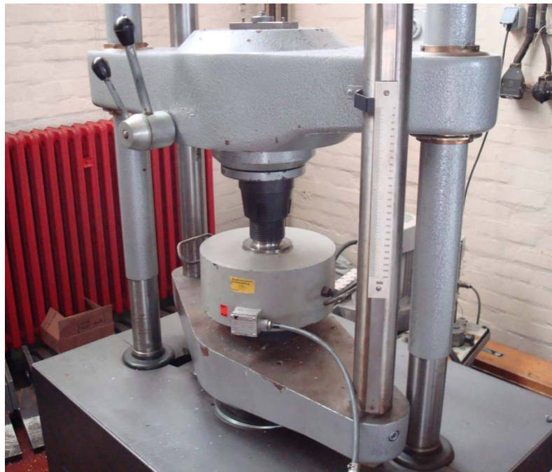
Slika 24 Tlačno predopterećenje kidalice i dinamometra
