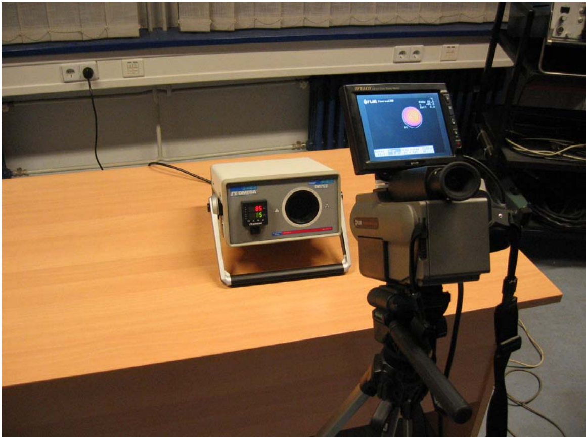
Slika 23. Određivanje točnosti IC-kamere
