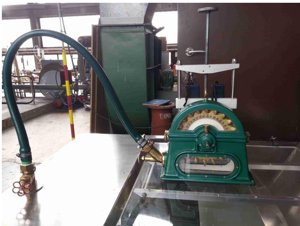
Slika 4. Model Pelton turbine na kojem se provodi eksperiment
