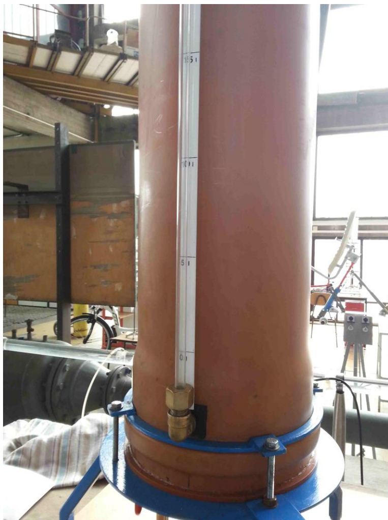
Slika 14. Oznake volumena na mjernoj posudi
