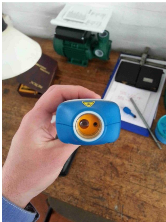
Slika 22. Prednji kraj digitalnog ručnog tahometra
